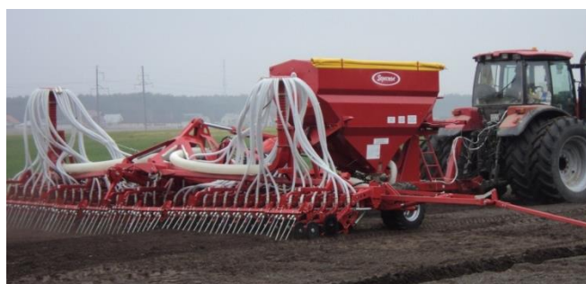
Рисунок 4 – Пневматическая широкозахватная сеялка С-9
