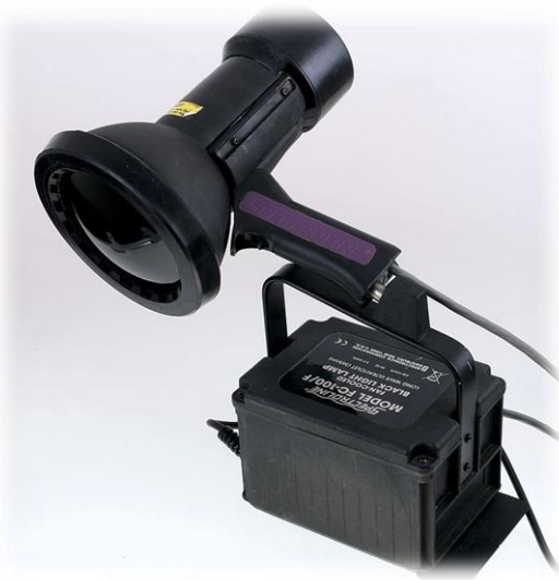
Рисунок 4.12 – Ультрафиолетовая лампа для обнаружения утечек за счет свечения индикаторного газа в ее лучах (модель Spectroline FC 100)
