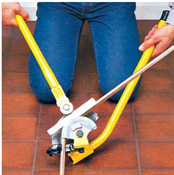
Рисунок 4.27 – Сгибание трубы под необходимый радиус
