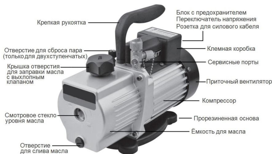
Рисунок 4.3 – Двухступенчатый вакуумный насос
