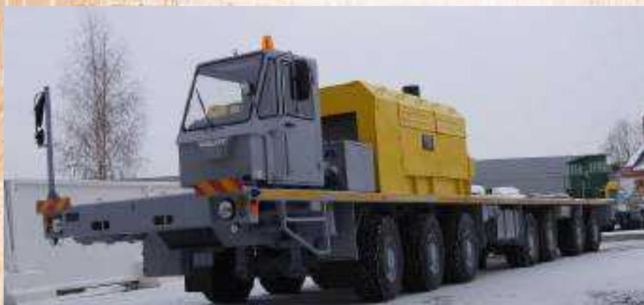
МЗКТ-800500 с приводом на все оси, с рамой-платформой (без надрамника для спецнастройки) предназначено для перевозки МБУ по бездорожью.
