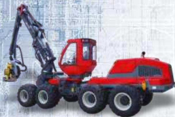
Машина лесная харвестер «БЕЛАРУС-SAMPO» МЛХ-265 предназначен для рубок прореживания и отвечает требованиям к этой операции. Отличная обзорность также обеспечивает высококачественную резку. Кабина вращается гидравлически и работает автоматически с возможностью регулировки положения кабины по отношению к повороту стрелы манипулятора, оператор может вручную регулировать поворот кабины.
