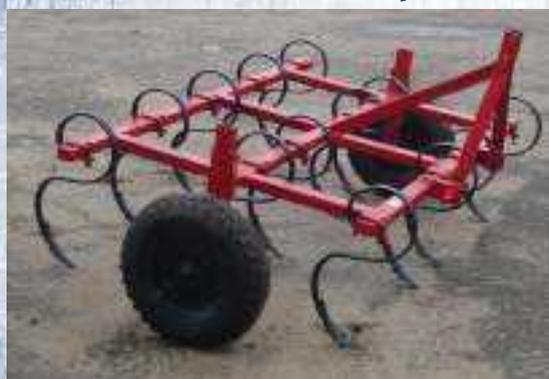
Предназначен для сплошной предпосевной и паровой обработки всех типов почв с засоренностью камнями не более 60мм.
