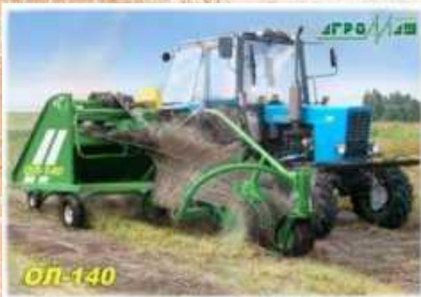
Оборачиватель предназначен для переворачивания льносоломки с целью ее естественной сушки, улучшения условий для процесса вылежки в тресту и последующим подбором и прессованием в рулоны пресс-подборщиком.
