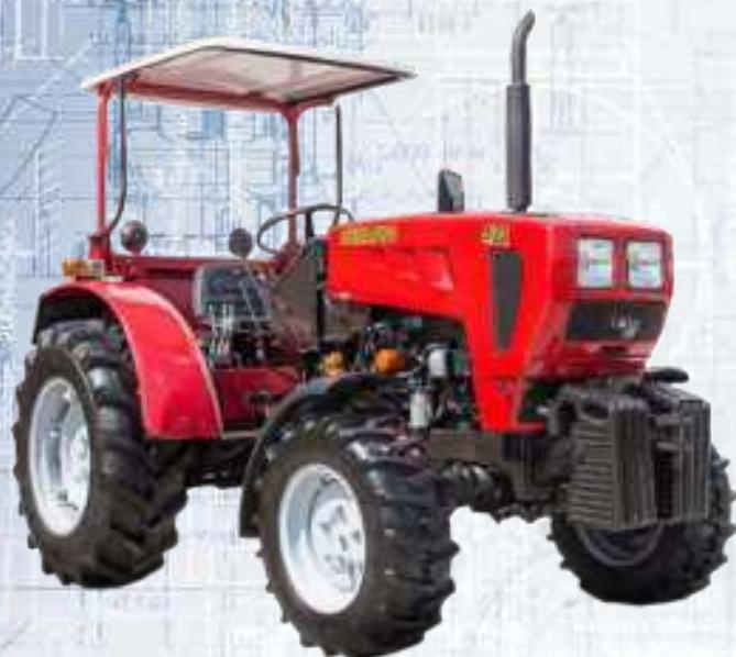
Данная модель демонстрирует эффективную работу на затопленной, влажной и сухой почвах в условиях повышенных температур. Высокий клиренс позволяет преодолевать различного рода препятствия, при этом не повреждая сельскохозяйственные культуры. Широкий диапазон КПП позволяет выбирать оптимальную скорость движения. Высокая грузоподъемность задней навески и двухскоростной ВОМ расширяют возможности для использования трактора с различными агрегатами.
