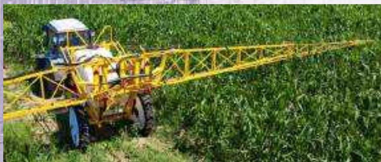
Предназначены для химической защиты растений в полевых условиях от сорняков, вредителей и болезней путем обработки полевых культур, в т.ч. возделываемых по интенсивной технологии, пестицидами, а также для внесения жидких комплексных удобрений путем поверхностного опрыскивания.
