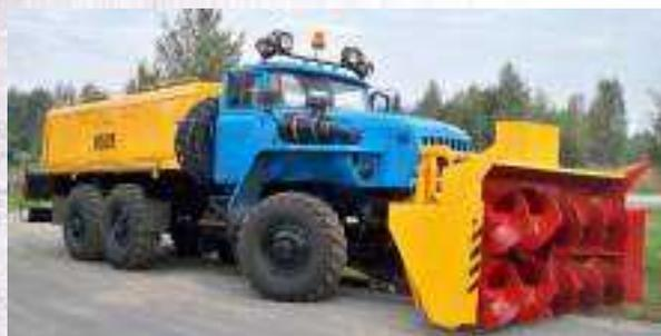
Снегоочиститель шнекороторный АМКОДОР 9531-03 на автошасси Урал-4320-41 с двигателем привода рабочего органа ЯМЗ-238НД5 предназначен для очистки от снега автомобильных дорог, отбрасывания снежных валов, образованных другими снегоочистителями, а также может использоваться для очистки аэродромных покрытий.
