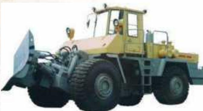
Предназначены для механизации земляных работ и разработки грунтов в карьерах, на крупных строительных объектах и других предприятиях
