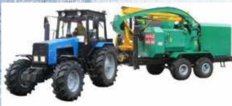
Машина рубильная «БЕЛАРУС» МР-100 предназначена для производства топливной щепы из круглых и колотых лесоматериалов, порубочных остатков, низкокачественной древесины, отходов лесопиления и деревообработки на конечном терминале, которым, как правило, является склад для подготовки топливного сырья мини-ТЭЦ, работающей на древесной щепе.
