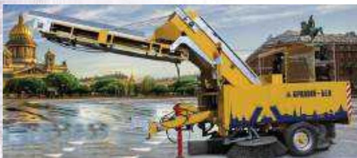
Прицепная подметально-уборочная машина «Бродвей-Бел» предназначена для уборки проезжей части. Подбор смета осуществляется механическим способом при помощи двух боковых и одной центральной щеток с последующей транспортировкой смета в кузов буксирующего самосвала. Для снижения пылеобразования и увеличения ресурса щеток используется орошение убираемой поверхности.
