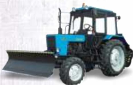
Машина уборочная «БЕЛАРУС» 82МК предназначена для очистки улиц, площадей, дорог и тротуаров с твёрдым покрытием от мусора и свежесвыпавшего снега, для планировки рыхлого насыпного грунта и засыпки им траншей и ям.
