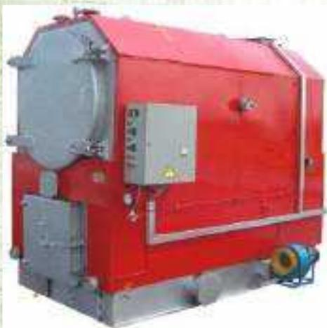
Котлы водогрейные КВ-0,75Г, КВ-0,75Ж с рабочим давлением воды до 0,6 МПа и максимальной температурой на выходе из котла до 95°С предназначены для систем отопления производственных, административных и жилых зданий. Область применения: стационарные котельные. Котёл применяется во всех электрифицированных зонах с питанием от сети переменного тока напряжением 380/220В с частотой 50 Гц.
