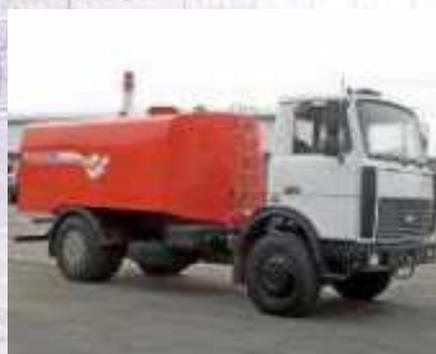
Каналопромывочная машина КО-514-1 предназначена для очистки ливневых канализационных труб от осадков и засоров. Специальное оборудование состоит из цистерны, водяного насоса с приводом, барабана с намотанным рукавом, гидравлической системы и вспомогательного оборудования. Насос и барабан с РВД размещены в отапливаемых отсеках.
