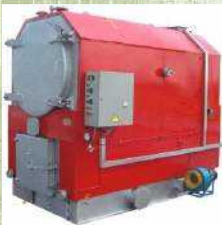
Котел водогрейный КВр(м)-0,75Т-007 (ручная или механизированная подача топлива) предназначен для сжигания дров, древесных отходов, торфобрикета и каменного угля с целью получения тепловой энергии для отопления и горячего водоснабжения жилых, производственных и административных зданий в закрытых системах теплоснабжения, в технологических процессах сушки древесины. Область применения: стационарные и блочно-модульные котельные
