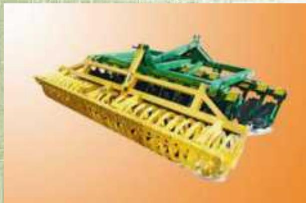
Агрегаты предназначены для смешивающей обработки стерни (лушение), для предпосевной обработки почвы после внесения жидкого навоза. Агрегаты оснащены мульчирующим катком, который служит для размельчения крупных комьев почвы, прикатывания и выравнивания, а также для разделки пластов почвы после вспашки лугов и пастбищ.
