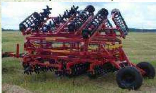
Агрегат комбинированный почвообрабатывающий АКШ-7,2-02 (АКШ-6,0-02; АКШ-3,6-02) предназначен для предпосевной обработки всех типов минеральных почв по фонам культивации и вспашки с заделкой развальных борозд (гладкая вспашка), агрегат качественно выполняет за один проход рыхление, выравнивание и прикатывание почвы с созданием в посевном слое уплотненного ложа для семян, обеспечивает ресурсосберегающую комплексную обработку почвы. Кроме того предусмотрена замена лопастных батарей на
