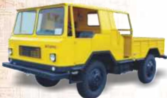
Машина грузолюдская шахтная «БЕЛАРУС» МГЛ-363М предназначена для перевозки людей и грузов по горизонтальным и наклонным горным выработкам арочного типа.
