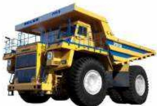
Карьерные самосвалы грузоподъемностью 110-136 тонн предназначены для перевозки горной массы в сложных горнотехнических условиях глубоких карьеров, на открытых разработках месторождений полезных ископаемых по технологическим дорогам в различных климатических условиях эксплуатации (при температуре окружающего воздуха от -50 до +50 градусов).
