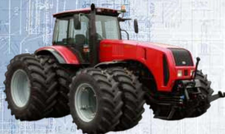
Трактор предназначен для выполнения энергоемких сельскохозяйственных работ в тяговом и тягово-приводном режимах в составе широкозахватных и комбинированных агрегатов, в том числе при эшелонированной навеске, на основной и предпосевной обработке почвы, посеве зерновых и других культур, заготовке кормов, уборке корнеплодов, зерновых и технических культур; для выполнения транспортных работ,
