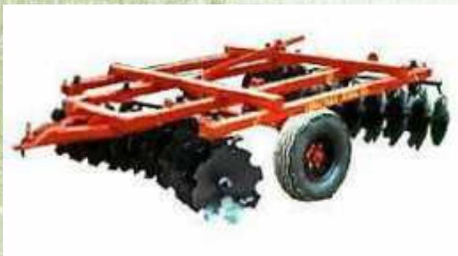
Борона БПД-3М применяется для разделки пластов почвы после вспашки земель, для предпосевной подготовки почвы без предварительной вспашки, для обработки после уборки пропашных культур, для ухода за лугами и пастбищами, засоренными мелкими камнями размером не более 10 см и древесными остатками толщиной до 2 см. Борона агрегируется с тракторами МТЗ-1221/1522, и другими тракторами класса 3, оснащенными раздельно-агрегаторной гидросистемой.
