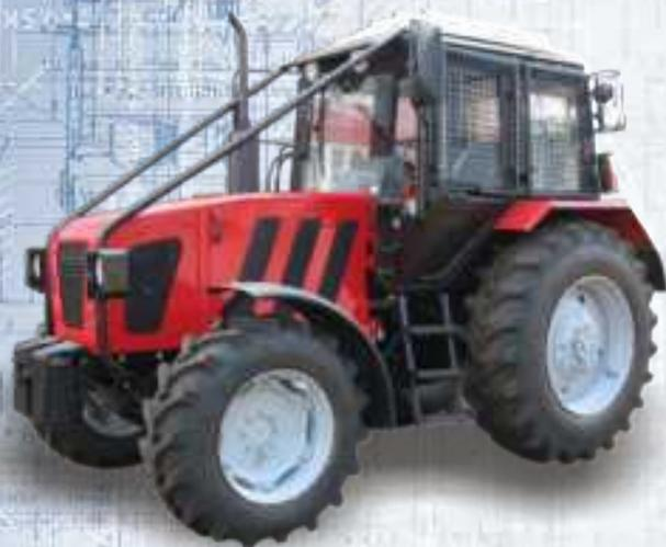
Трактор лесохозяйственный «БЕЛАРУС» Л952.4 предназначен для выполнения работ по лесовозобновлению и уходу за лесосекой после вырубке леса, а также при использовании навесного и прицепного оборудования для сбора и транспортирования сортиментов, их погрузки-разгрузки и др.
