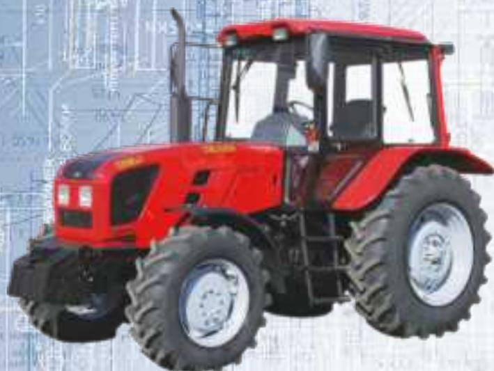
Трактор предназначен для выполнения различных сельскохозяйственных работ с навесными, полунавесными и прицепными машинами и орудиями, работ на транспорте.
