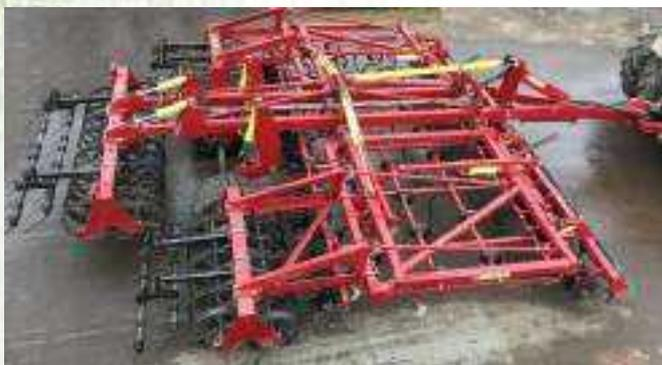
Агрегат выполняет минимальную обработку почвы на глубину до 16 см и предназначен для лущения жнивья, полупаровой осенней обработки зяби, осенней обработки полей после уборки кукурузы, свеклы и картофеля, ранневесенней обработки зяби (закрытие влаги и заделка минеральных удобрений), а также для подготовки окультуренных почв за два прохода под посев озимых зерновых, пожнивных и поукосных культур.
