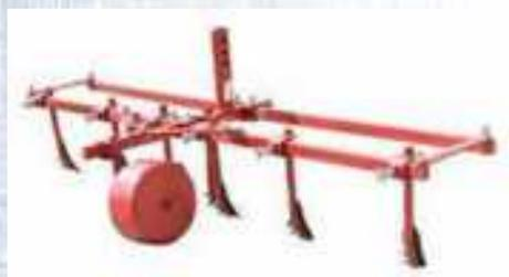
Предназначен для рыхления почвы, выравнивания поверхности, заделки семян и удобрений, подрезания сорняков.
