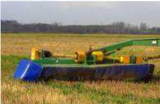
Косилка КДН-310 предназначена для скашивания естественных и сеяных трав с одновременной укладкой скошенной массы в валок или прокос. Косилка КДН-310 имеет возможность автоматически подстраиваться под рельеф даже при значительных неровностях почвы.
