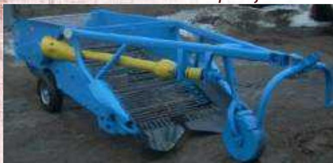
Картофелекопатель элеваторный полунавесной КЭП-1,4 предназначен для выкапывания картофеля, частичного отделения клубней от почвы и укладки их на поверхность поля для дальнейшей подборки.
