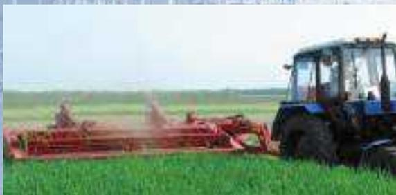
Прицепная косилка-плющилка КПП-4,2 «ПАЛЕССЕ СТ42» предназначена для кошения трав с одновременным плющением скошенных растений и укладкой их на стерню в валок. Косилка может быть использована на скашивании трав без плющения со сбором массы в валок. Косилка-плющилка агрегируется с тракторами тягового класса 1,4
