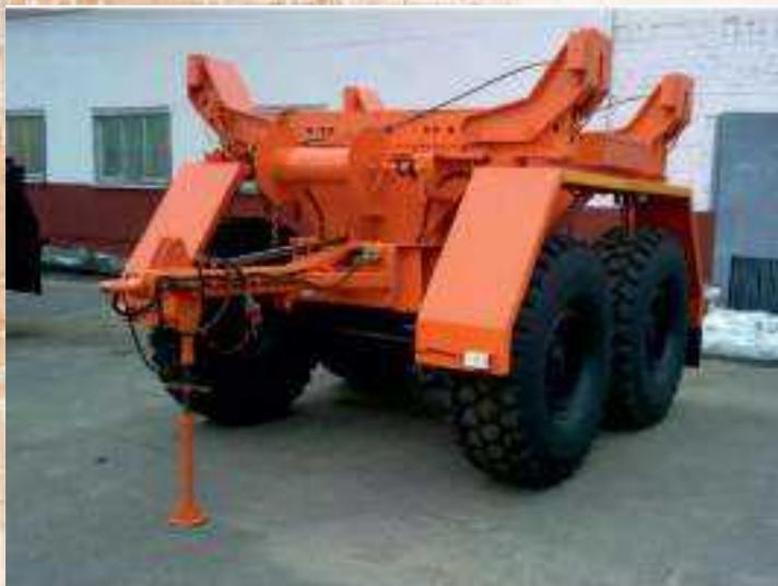
Предназначен для перевозки плетей труб диаметром от 529 до 1420 мм длиной до 36 м при строительстве трубопроводов.
