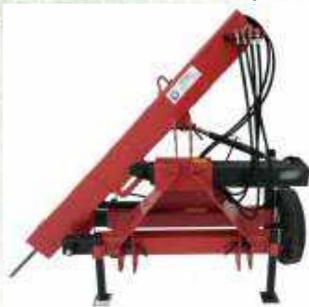
Подрезание корней - новый и очень эффективный способ уменьшить разрастание кроны плодовых деревьев. Подрезка корней происходит быстро и эффективно. Устройство, благодаря гидравлически регулируемой рабочей ширине и глубине, может работать с тракторами различных колесных баз. Управление осуществляется из кабины трактора. Глубина входа лезвия в почву до 60см.
