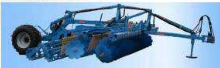
Агрегат дисковый почвообрабатывающий АД-600 «Рубин» предназначен для лущения стерни зерновых культур, обработки полей после уборки кукурузы, технических культур и полей с сидератами, обработки залежных земель, разделки пластов почвы после вспашки, а также
