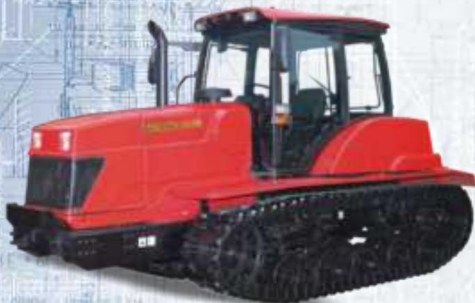
Сельскохозяйственный гусеничный трактор предназначен для работы в сельском хозяйстве с навесными, полунавесными, прицепными машинами, в том числе для работ общего назначения на переувлажненных почвах.
