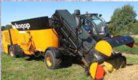
Предназначен для самозагрузки стельчатых, сыпучих кормов с измерением массы, смешивания всех кормовых смесей для раздачи животным на фермах КРС в 800 и более голов.
