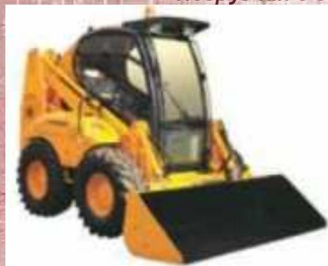
Амкодор 211 предназначен для механизации погрузочно-разгрузочных и выполнения землеройно-транспортных работ на грунтах I и II категории, выполнения складских работ со штабелируемыми грузами, очистки дорог от мусора и снега, ухода за территориями, а также для выполнения различных специальных и вспомогательных работ.
