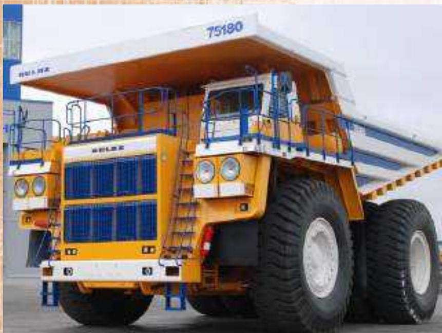
Карьерные самосвалы грузоподъемностью 180 тонн предназначены для перевозки горной массы в сложных горнотехнических условиях глубоких карьеров, на открытых разработках месторождений полезных ископаемых по технологическим дорогам в различных климатических условиях эксплуатации (при температуре окружающего воздуха от -50 до +50 градусов).
