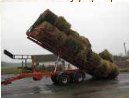
Предназначен для транспортировки и механизированной загрузки и разгрузки запрессованных грубых кормов, льна плотностью до 400 кг/м<sup>3</sup>. Полуприцеп агрегируется с тракторами класса 2- 3, имеющие гидросистему, тягово-сцепное устройство, выходы электрооборудования и пневмопривод тормозов. Полуприцеп используется для эксплуатации в производственных условиях сельскохозяйственных предприятий.
