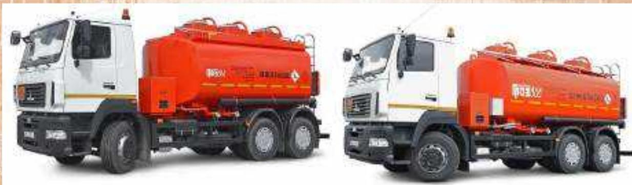
Автотопливозаправщик АТЗ-2-15-56215-0000010-09 (АТЗ-3-17-6312В5-456-012) предназначен для транспортировки, кратковременного хранения и заправки светлыми нефтепродуктами плотностью не более 0,86 т/м<sup>3</sup> и является мерой полной вместимости. Корпус цистерны выполнен в виде горизонтального резервуара с внутренними ребрами жесткости (волнорезами) плосковыгнутой формы, которые усиливают надежность всей конструкции цистерны и препятствуют возникновению гидроударов.
