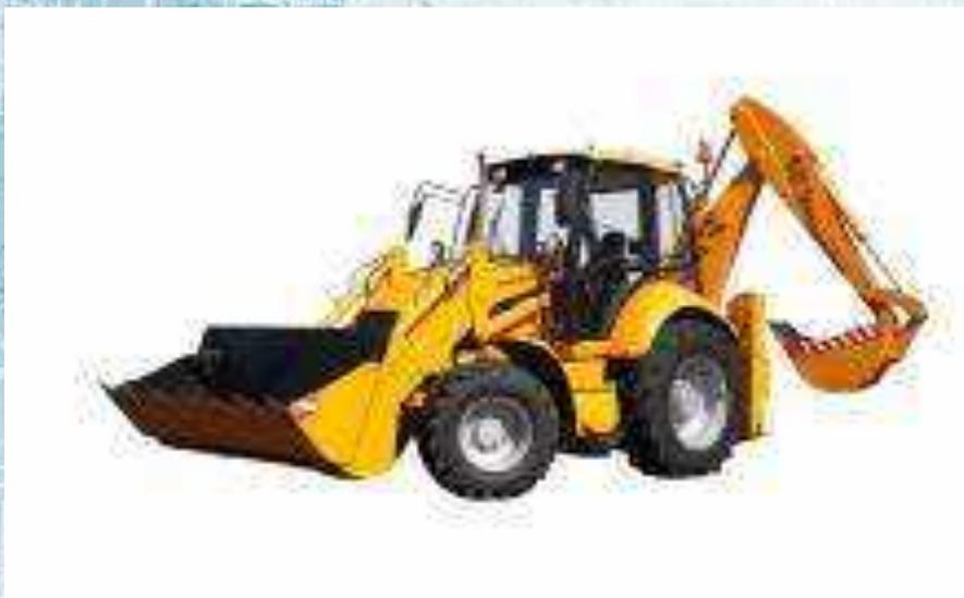
Экскаватор-погрузчик АМКОДОР 732 предназначен и может быть использован для выполнения работ в строительстве, коммунальном и сельском хозяйстве. Экскаватор-погрузчик включает в себя фронтальное погрузочное оборудование с основным ковшем и заднее экскаваторное оборудование типа обратная лопата.
