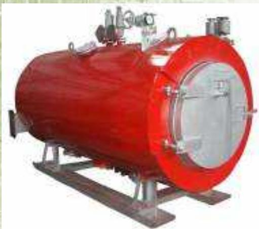
Котел стальной паровой КП-300Т/0,9 (300 кг пара в час) с давлением пара не более 0,9 МПа (9,0 бар) предназначены для технологических процессов в сельскохозяйственном, строительном-дорожном, хлебопекарном и других производствах. Область применения: стационарные, блочно-модульные котельные. Котел применяется во всех электрифицированных зонах с питанием от сети переменного тока напряжением 380/220В с частотой 50 Гц.
