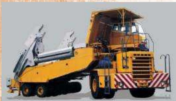
Предназначены для транспортировки жидкого шлака в ковшах на металлургических предприятиях.
