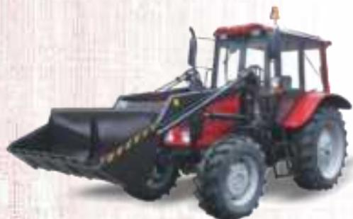
Оборудование погрузочное П10М в составе трактора предназначено для выполнения погрузочно-разгрузочных работ, транспортных работ по перевозке сыпучих материалов на небольшие расстояния, работ по планировке площадок, засыпке траншей и ям насыпным грунтом, работ по очистке дорог, тротуаров и площадей от свежесвыпавшего снега.
