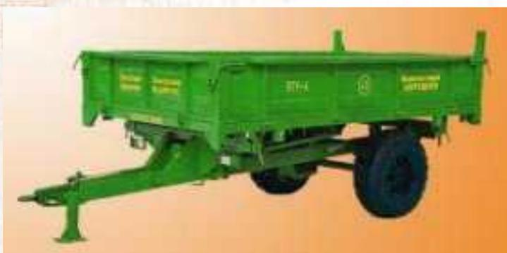
Полуприцеп без надставных бортов ПТУ-4 предназначен для транспортирования различных строительных и сельскохозяйственных сыпучих грузов.
