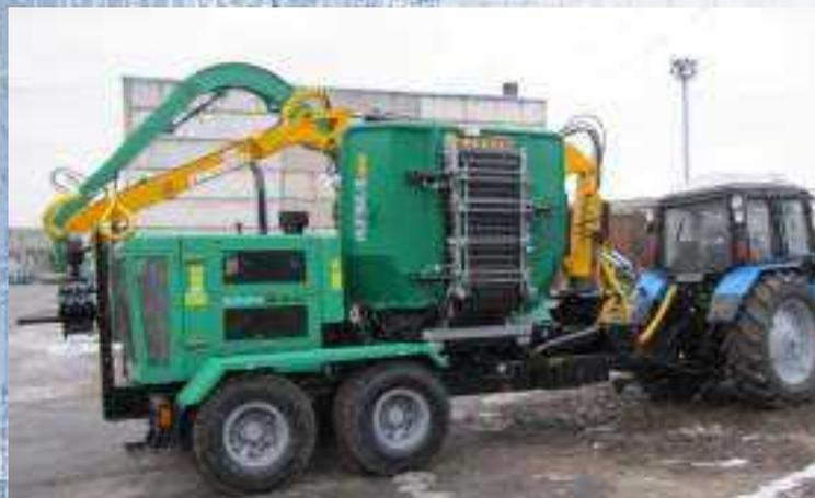
Машина рубильная «БЕЛАРУС» МР-40-3 предназначена для производства технологической щепы из круглых и колотых лесоматериалов, низкокачественной древесины, отходов лесопиления и деревообработки. Поставляется с гидроманипулятором ГМ-42Т-01 либо ГМ-50-01 и управляется машиной из кабины трактора Л1221.
