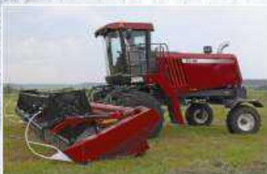
Использование самоходной косилки ПАЛЕССЕ позволяет эффективно решать задачи отдельной уборки зерновых колосовых, зернобобовых, крупяных культур, а также заготовки кормов из трав. Косилка с валковой транспортерной жаткой обеспечивает скашивание растений и их укладку в центральный, левосторонний или правосторонний валок.
