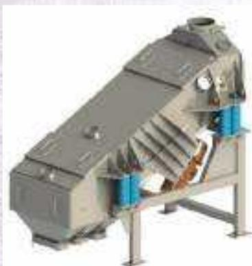
Просеиватель гранул ПГ-15 предназначен для контроля по крупности продукта (гранул, крупки). В процессе работы продукт подаётся на сита, совершающие колебательные движения, в зависимости от крупности продукт разделяется и идет сходом, либо проходом к выгрузным патрубкам. В данной машине реализована возможность установки сит в два яруса, соответственно машина разделяет продукт на три фракции.
