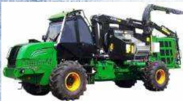
Предназначена для рубки в щепу круглого леса, низкокачественной древесины, порубочных остатков, отходов лесопиления, дров и прочих лесоматериалов.
