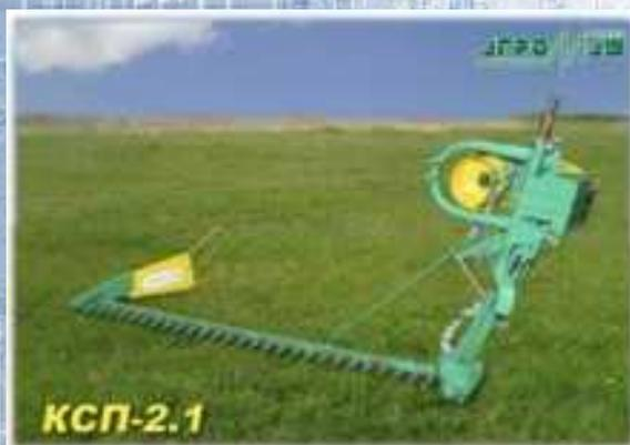
Сегментно-пальцевая навесная косилка предназначена для использования на равнинных участках местности и применяется для работы с различными типами сеяных и естественных трав. Эта сегментно-пальцевая модель приводится в действие при помощи вала отбора мощности трактора, относящегося к тяговому классу 0,6-1,4 (агрегатируется с трактором методом навески).
