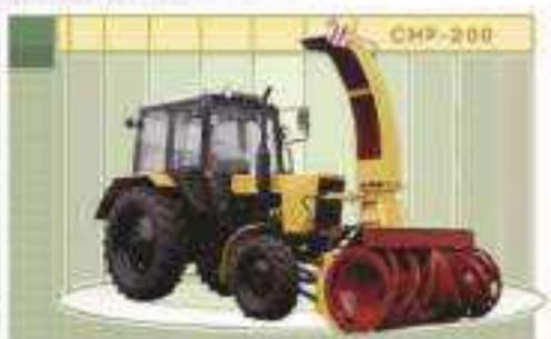
Снегоочиститель фрезерно-роторный СНР-200 может использоваться для удаления снежных валов, образованных бульдозерами и плужными снегоочистителями. При необходимости СНР-200 может обеспечивать перекидку снега или укладку его в валы. Снегоочиститель предназначен для эксплуатации в условиях умеренного климата при температуре воздуха от -40С до +35С.
