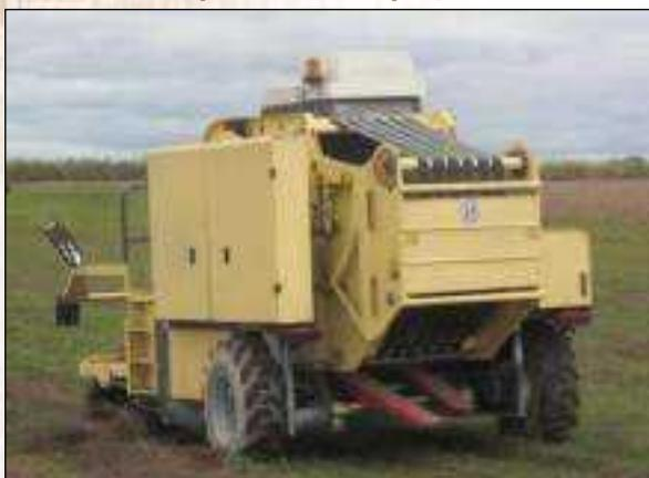
Пресс-подборщик лент льна самоходный однорядный рулонный ПРС-1 «DEHONDT» предназначен для подбора лент льносолумы и льнотресты влажностью не более 20% с прессованием в рулоны цилиндрической формы, с прокладкой шпагата по всей длине ленты льна и последующей внешней обвязкой.
