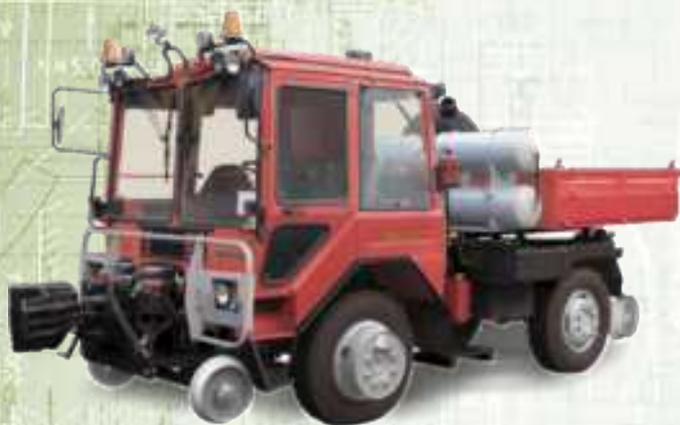
Машина универсальная «БЕЛАРУС» МУ-466 предназначена для использования в качестве локомотива для выполнения маневровых работ на внутризаводских ж/д путях колеи 1520 мм, а также для круглогодичного содержания и уборки дорог общего пользования, благоустройства производственных территорий.
