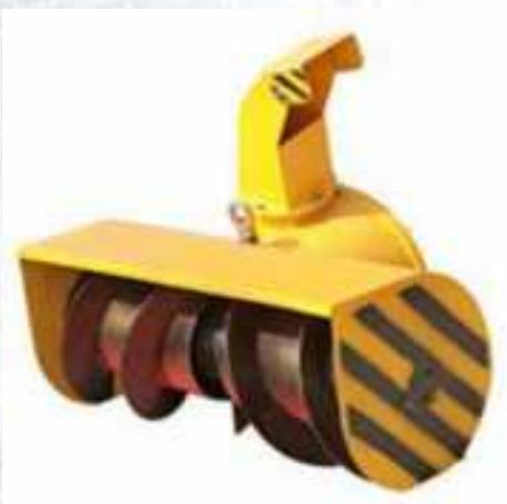
Предназначен для очистки от снега территорий, на которых применение высокопроизводительных уборочных машин невозможно или нецелесообразно.
