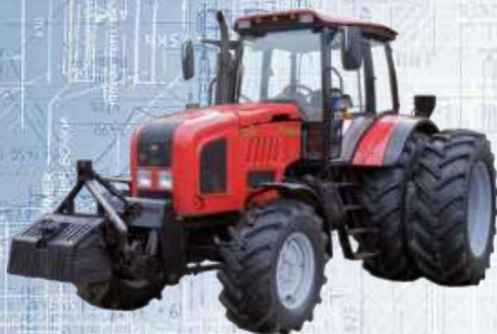
Предназначен для выполнения энергоемких сельско-хозяйственных работ в тяговом и тягово-приводном режимах в составе широкозахватных и комбинированных агрегатов, в том числе при эшелонированной навеске.
