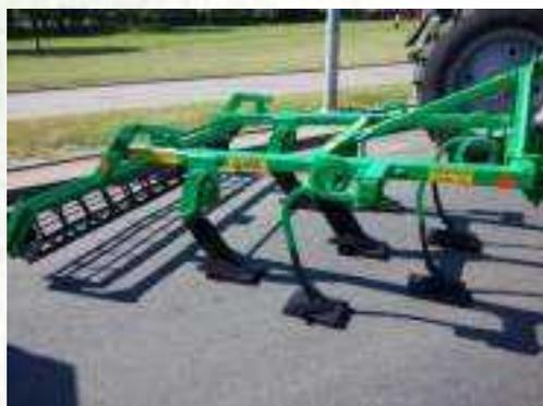
Агрегат почвообрабатывающий комбинированный (в дальнейшем агрегат) предназначен для сплошной обработки пахотного горизонта почвы с одновременной поверхностной обработкой: дроблением крупных комьев почвы, выравниванием и прикатыванием поверхности поля.
