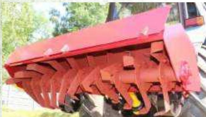
Фреза садовая ФС-У (углубленная) предназначена для сплошной обработки почвы. Применяется в садоводстве, растениеводстве и иных сельскохозяйственных работах. Регулировка глубины обработки производится при помощи опорных колёс.
