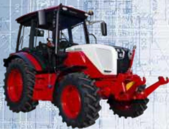
Трактор предназначен для выполнения различных сельскохозяйственных работ с навесными, полунавесными и прицепными машинами и орудиями, для выполнения погрузочно-разгрузочных работ, работ на транспорте, привода стационарных сельскохозяйственных машин.
