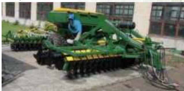
рыхление, мелкоструктурное крошение, выравнивание и подуплотнение семенного ложа, высева семян и удобрений и заделку их почвой на требуемую глубину.
