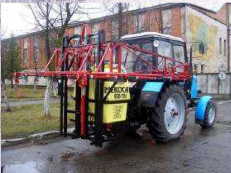
Опрыскиватель предназначен для химической защиты полевых сельскохозяйственных культур, а также для поверхностного внесения жидких минеральных удобрений. Агрегируется с трактором класса 1,4-2,0
