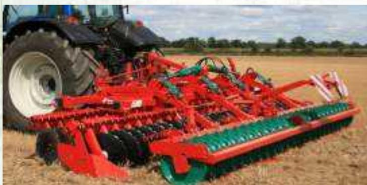
Предназначен для основной и предпосевной обработки почвы под зерновые, технические и кормовые культуры, а также лущения стерни, улучшения пастбищ и лугов. Оборудован двумя рядами сферических дисков с фиксированным углом атаки и прикатывающим катком. Агрегат производит измельчение и заделку растительных остатков и сорной растительности, обрабатывает почву сдвигая ее, а не переворачивая, что предотвращает выветривание
