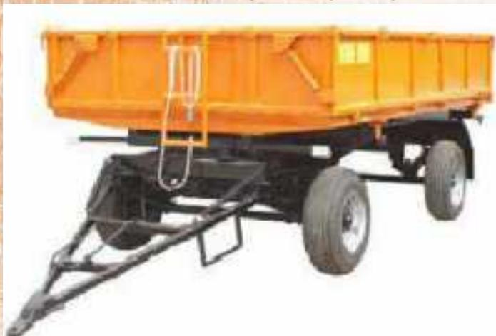
Прицеп тракторный самосвальный ПСМ-4,5 предназначен для перевозки грузов сельскохозяйственного, строительного и коммунального назначения по дорогам общей сети и в полевых условиях. Прицеп для сельскохозяйственной техники оснащен вместительной платформой, которая опрокидывается на 3 стороны. Агрегируется с тракторами класса 1,4 тс, имеющими сцепное устройство ТСУ-1, выходы электрооборудования, пневмо и гидросистемы.
