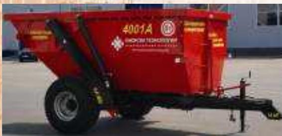
Полуприцеп тракторный самосвальный предназначен для перевозки и выгрузки назад любых жидких, полужидких и сыпучих сельскохозяйственных и строительных грузов по дорогам общего пользования и в полевых условиях.
