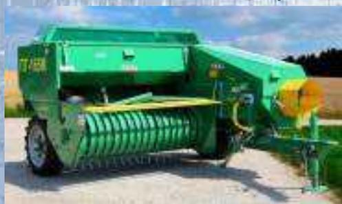
Пресс-подборщик тюковый ППТ-160 применяется для подбора валков сена, соломы, прессования их в прямоугольные тюки. Пресс-подборщик агрегируется с тракторами тягового класса 1,4. В отличие от рулонных пресс-подборщиков тюковая машина позволяет регулировать плотность тюка, к тому же выходные габариты и масса получаемого тюка намного меньше. Это позволяет разгружать и раздавать тюки не только с помощью техники, но и в ручную, это удобно и при последующем их скармливании. Данный пресс-
