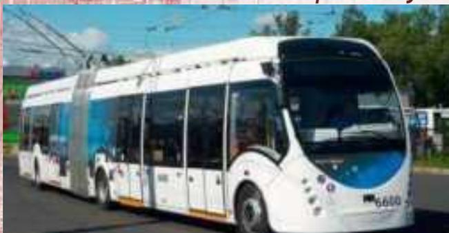
Троллейбус модели 43303 - это трехосный сочлененный низкопольный троллейбус с транзисторной системой управления на IGBT-модулях.
