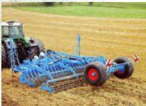
Предназначена для обработки залежных земель, полей с полеглими зерновыми или с соломой от кукурузы, а также с высокостебельными сидератами.
