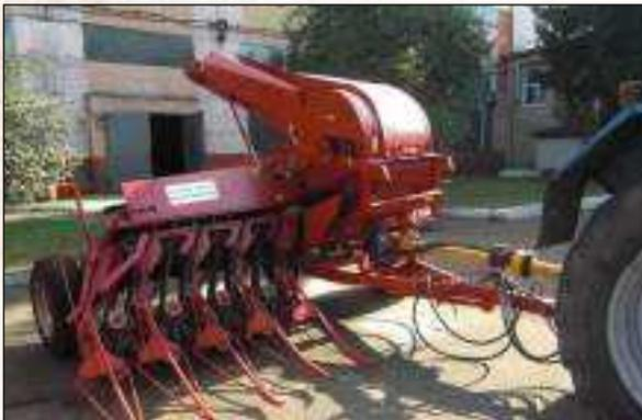
Комбайн льноуборочный Двина-4М предназначен для тербления стеблей льна-долгунца в период ранней желтой и желтой спелости с одновременным очесом семенных коробочек, сбором очесанного вороха в прицеп и расстилом стеблей в ленту.
