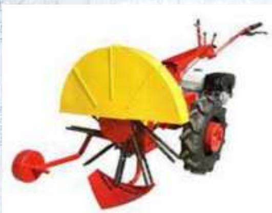
Предназначена для выкапывания картофеля на небольших площадях посадки.
