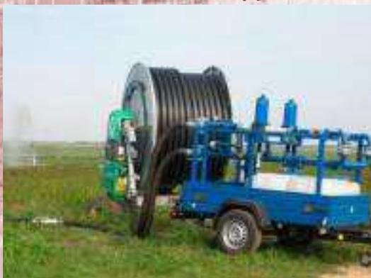
Оборудование для гидроподкормки к дождевальным установкам (в дальнейшем оборудование) предназначено для дозированного ввода микроудобрений.
