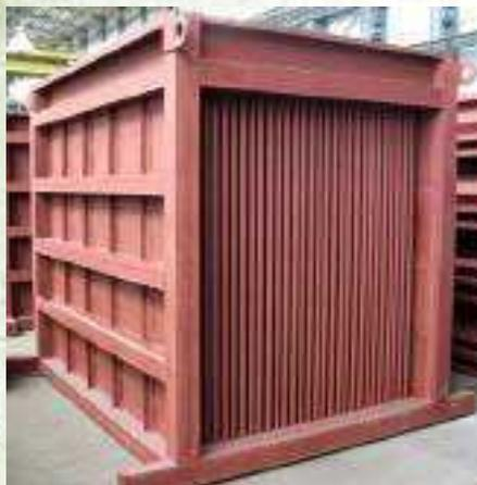
Секции кубов воздухоподогревателей для котельных агрегатов выполняются из труб  $\varnothing 40$  мм и  $\varnothing=51$  мм с толщиной стенки 1,5 мм. Применяются для предварительного подогрева воздуха (до 450 °С), поступающего в топку котельных агрегатов электростанций.
