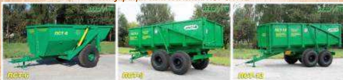
Полуприцеп самосвальный тракторный ПСТ предназначен для транспортировки различных сельскохозяйственных грузов, зерна, корнеплодов, органических удобрений, строительных материалов и других грузов, в том числе полужидких, с выгрузкой их назад.
