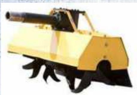
Фреза почвенная ФР-00010 предназначена для обработки почвы под посадки овощных культур, а также для осенней обработки почв различного состава с уклоном местности до 10 градусов.
