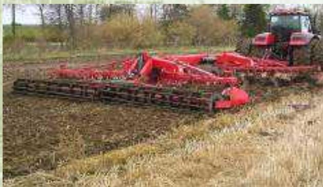
Агрегат предназначен для лущения жнивья, полупаровой осенней обработки зяби, осенней обработки полей после уборки кукурузы, свеклы и картофеля, ранневесенней обработки зяби, а также для подготовки окультуренных почв за два прохода под посев озимых зерновых, пожнивных и поукосных культур.
