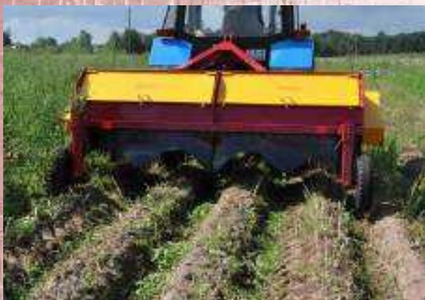
Предназначена для сбивания и измельчения ботвы картофеля с копированием профиля гребней 70, 75, 90 см, а также для измельчения ботвы овощных культур (морковь и др.) и пожнивных остатков (кукурузы, капусты и др.). Машина работает на почвах, не засоренных камнями, или засоренных отдельными мелкими камнями диаметром до 6 см. Уклон местности не более 8 градусов. Машина агрегируется с тракторами тягового класса 1,4-2,0 кН.
