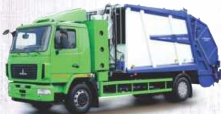
Предназначены для механизированной и ручной загрузки, уплотнения, транспортировки и выгрузки твёрдых коммунальных отходов
