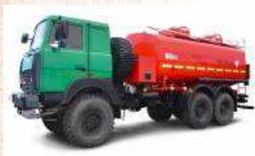
Автотопливозаправщик АТЗ-2-20-56091-0000010-06 предназначен для транспортировки, кратковременного хранения и заправки светлыми нефтепродуктами плотностью не более 0,86 т/м<sup>3</sup> и является мерой полной вместимости. Корпус цистерны выполнен в виде горизонтального резервуара с внутренними ребрами жесткости (волнорезами) плосковыгнутой формы, которые усиливают надежность всей конструкции цистерны и препятствуют возникновению гидроударов.
