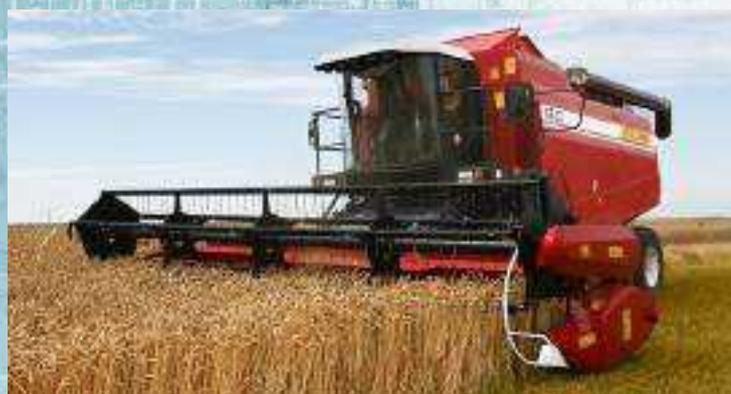
Зерноуборочный комбайн КЗС-1218 «ПАЛЕССЕ GS12» - высокопроизводительный комбайн с молотильно-сепарирующим устройством шириной 1500 мм, в котором применено ускорение потока хлебной массы перед обмолотом. При этом отличительной особенностью молотилки ПАЛЕССЕ GS12 являются большие диаметры барабана-ускорителя и молотильного барабана (600 и 800 мм) - больше, чем в любой другой молотилке аналогичного типа.
