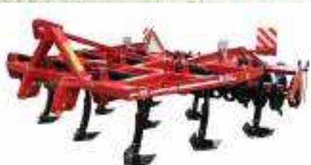
Культиваторы серии КГН - это универсальные навесные трехрядные агрегаты, предназначенные для обработки стерни, заделки органических удобрений, глубокого рыхления до 35 см, предпосевной подготовки почвы.
