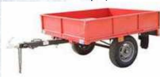
Прицеп автомобильный П05.02 "Беларус" предназначен для работы с легковыми автомобилями всех типов, оборудованными тягово-сцепным устройством шарового типа по ОСТ 37.001.096-84. Оборудован откидными бортами, пружинной подвеской с гидравлическими амортизаторами и реактивными тягами. Имеет усиленную раму.
