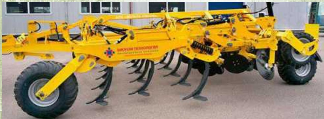
Агрегат почвообрабатывающий комбинированный «Дельта 436/450» многофункциональный полунавесной, гидравлически складываемый агрегат.
