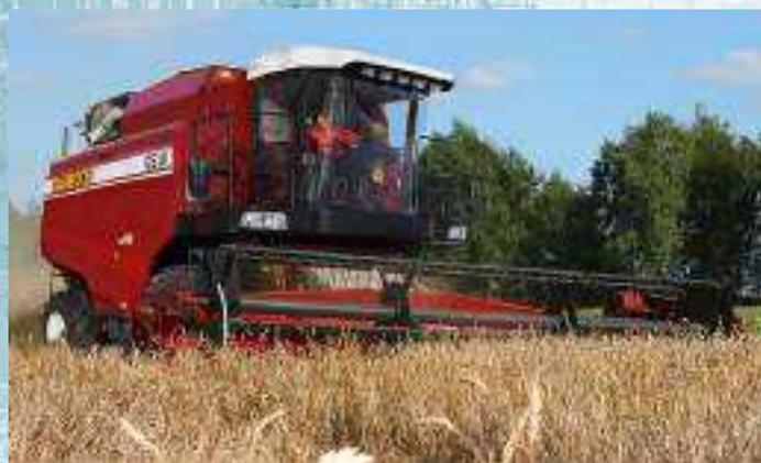
Зерноуборочный комбайн КЗС-10К «ПАЛЕССЕ GS10» - это, с одной стороны, классическая однобарабанная схема обмолота и сепарации, сочетающая стабильность и качество обмолота с экономичностью в эксплуатации. С другой стороны - это передовые технические решения, такие, как жатка с лучшим в мире режущим аппаратом, трехкаскадная очистка и высокий уровень автоматизированного управления параметрами уборки. Сочетание этих качеств с учетом умеренной цены дает все основания считать ПАЛЕССЕ GS10 «золотой
