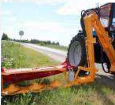
Предназначена для окашивания травянистой растительности, а также мелкого кустарника, диаметр стеблей которых не превышает 20 мм, растущих на откосах, дамбах, осушительных и оросительных каналах глубиной до 2-х метров.
