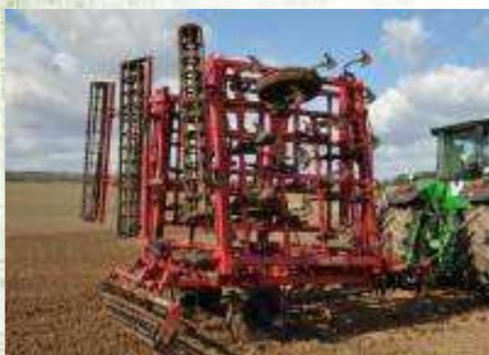
Предназначен для ранневесеннего закрытия влаги, паровой и предпосевной обработки всех типов минеральных почв, за один проход по полю обеспечивает полную подготовку почвы к посеву, совмещая культивацию, рыхление, выравнивание и предпосевное прикатывание почвы с созданием в посевном слое уплотненного ложа для семян.
