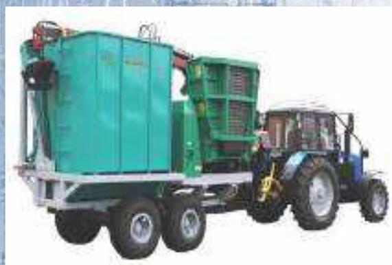
Машина рубильная «БЕЛАРУС» МР-25 предназначена для производства топливной щепы из круглых и колотых материалов, низкокачественной древесины, отходов лесопиления и деревообработки непосредственно на лесосеке.
