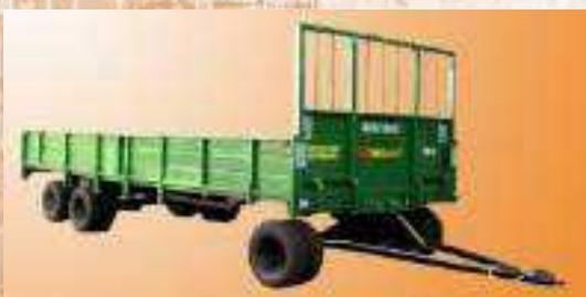
Предназначен для перевозки рулонов льнотресты, сена, соломы с поля в склады на хранение. Возможно использование прицепа для перевозки легковесных грузов.
