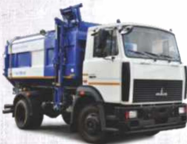
Предназначены для механизированной загрузки из контейнеров, уплотнения, транспортировки и выгрузки твердых коммунальных отходов
