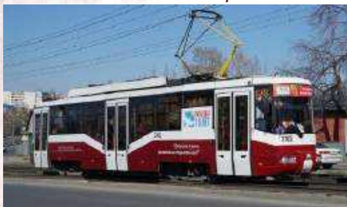
Вагон трамвайный модели 62103 - односекционный, трехдверный, с двумя моторными тележками, с транзисторной системой управления асинхронными тяговыми электродвигателями и переменным уровнем пола. Предназначен для эксплуатации на трамвайных линиях с шириной колеи 1524 мм.
