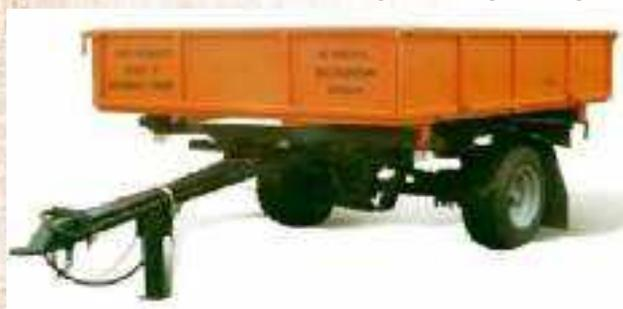
Полуприцеп предназначен для транспортирования различных строительных и сельскохозяйственных грузов, корнеплодов, органических удобрений по дорогам общей сети и в полевых условиях. Полуприцеп агрегируется с колесными тракторами тягового класса 0,6...1,4 тс, имеющими сцепное устройство ТСУ-1, выходы гидросистемы и электрооборудования, пневмопривод тормозов.
