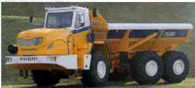
Предназначены для перевозки насыпных грузов и рассчитаны на эксплуатацию в различных климатических условиях как по специальным технологическим дорогам, так и в условиях бездорожья на грунтах с низкой несущей способностью.
