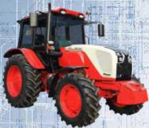
Трактор предназначен для выполнения различных сельскохозяйственных работ с навесными, полунавесными и прицепными машинами и орудиями, для выполнения погрузочно-разгрузочных работ, работ на транспорте, привода стационарных сельскохозяйственных машин.
