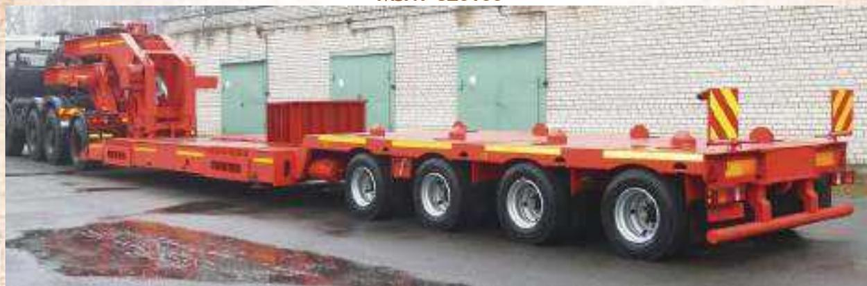
Предназначен для перевозки тяжелой техники и крупногабаритных неделимых грузов в составе автопоездов.
