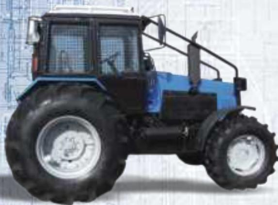
Трактор лесохозяйственный «БЕЛАРУС» Л1221.1 предназначен для выполнения различных работ по лесовозобновлению и уходу за лесом, а также транспортных работ при заготовке леса.
