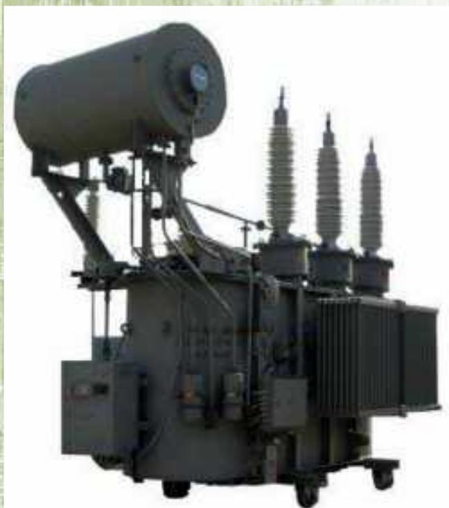
**ТМН-2500/110-У1** - силовой масляный трехфазный трехобмоточный трансформатор общего назначения с регулированием напряжения под нагрузкой, с системой охлаждения вида «М» - естественной циркуляцией воздуха и естественной циркуляцией масла, предназначен для работы в умеренном климате в условиях наружной установки. Климатическое исполнение У, категория размещения 1 по ГОСТ 15150.
