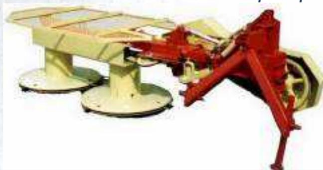
Косилка предназначена для скашивания травы на полях и лугах очищенных от камней с укладкой скошенной травы в прокос. Скашивание происходит за счет вращения двух роторов с ножами. Агрегируется с тракторами с тяговым усилием 0,9 и 1,4 кН.
