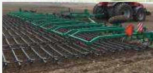
Зубовая борона БЗ-22 позволяет обрабатывать почву шириной 22 м за один проход. Возможно изготовление бороны зубовой с шириной захвата 18 м. На центральную и боковые рамы навешиваются секции зубчатые: на БЗ-18 - 10 секций на БЗ-22 - 12 секций, длина шлейфа - 16 рядов. Расположение рабочих органов (зубов) бороны в 16 рядов позволяет получить высочайшее качество предпосевной обработки почвы.
