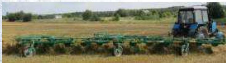
Габли колесно-пальцевые ГРЛ-8.5 (далее - габли) предназначены для сгребания провяленной травы из прокосов в валки и оборачивания валков.
