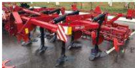
Культиваторы КН-3-П предназначены для работы на всех типах почв при технологии мульчированного посева на стерневых фонах или после уборки, картофеля и других культур. В качестве рабочих органов используется стрельчатая плоскорежущая лапа для стерневых фонов и дисковая балка со сферическими дисками.
