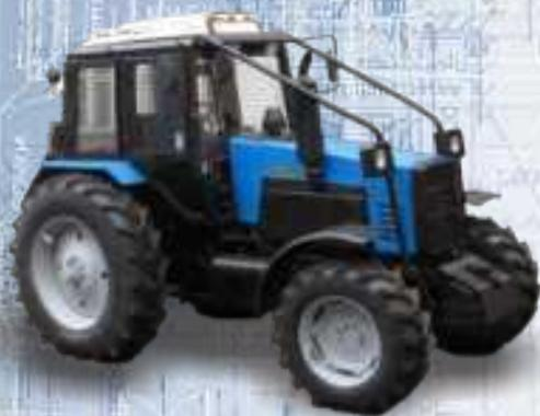
Трактор лесохозяйственный «БЕЛАРУС» Л1221 предназначен для выполнения различных работ по лесовозобновлению и уходу за лесом, а также транспортных работ при заготовке леса.
