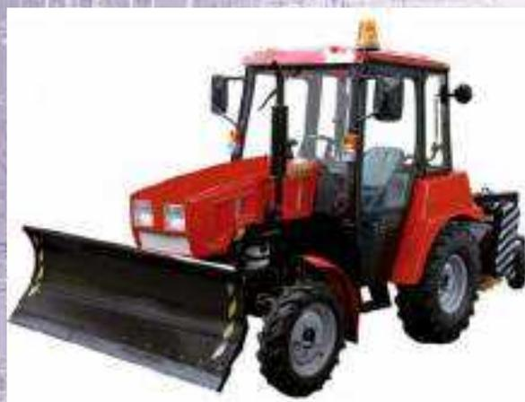
Машина состоит из базового трактора БЕЛАРУС 320.4 и плужно-щеточного оборудования.
