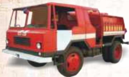
Машина пожарная шахтная «БЕЛАРУС» МП-403М предназначена для доставки боевого расчёта из шести человек на место пожара и его тушения в подземных рудниках арочного типа.
