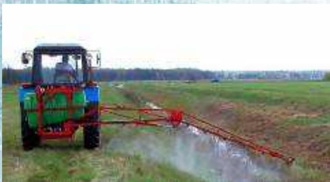
**Назначение:** химическая обработка мелиоративных каналов и дорожных обочин, трассы газо-нефтепроводов, контрольно-следовых полос и др.
