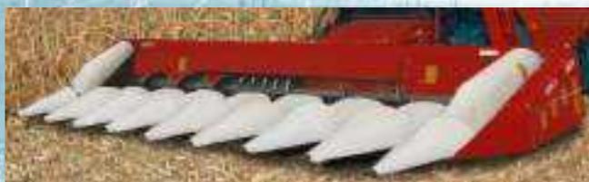
Комплект оборудования для уборки кукурузы на зерно КОК-8-2 с жаткой «Палессе-OROS МН853» предназначен для уборки кукурузы на зерно в составе зерноуборочного комбайна КЗС-1218 «Палессе GS12». Комбайн с комплектом оборудования для уборки кукурузы на зерно производит отделение початков от стеблей кукурузы, срезание, измельчение и разбрасывание стеблей по полю, вымолот зерна из початков, очистку и сбор очищенного зерна в бункер.
