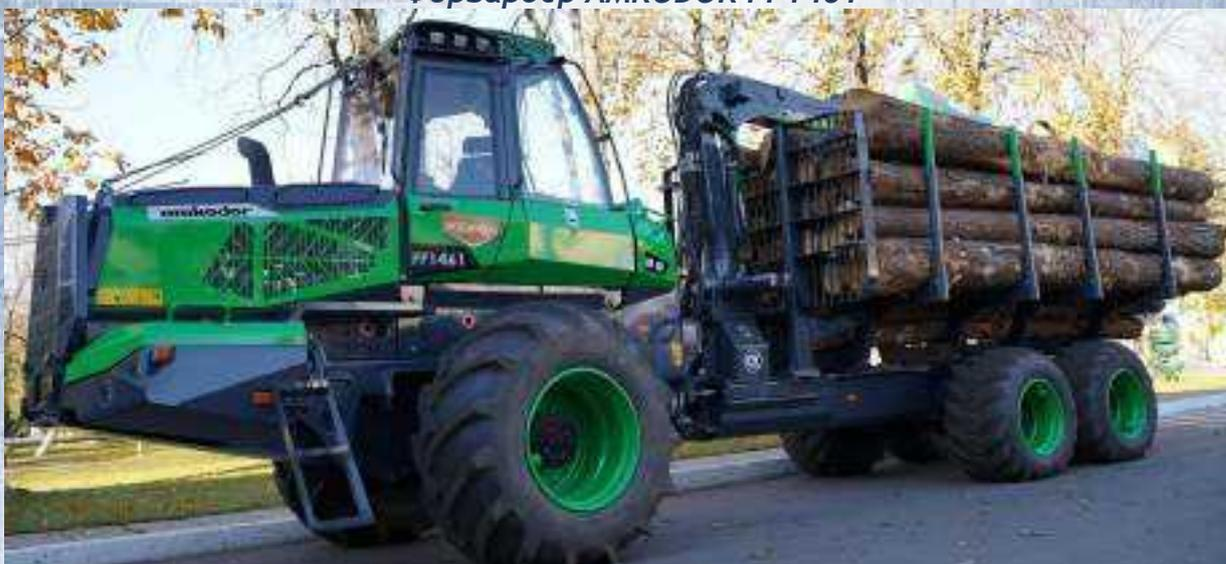
Форвардер АМКОДОР FF1461 с колесной формулой 6×6 и грузоподъемностью 14 тонн. Форвардер имеет широкий диапазон опций: удлинитель грузового отсека, уширители грузового отсека, систему продольного и вертикального перемещения щита, отвал, лебедку.
