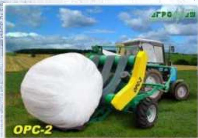
Обмотчик рулонов ОРС-2 - полуприцепного типа, с самозагрузкой, предназначен для герметизации рулонов из высококачественных подвяленных трав самоклеящейся синтетической плёнкой. Агрегируется с колесными тракторами класса 1,4 с ТСУ-1Ж, выводы гидросистемы и розетку.
