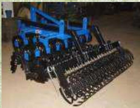
Агрегат АДН «ДИСКАТОР» применяется в составе комплекса машин в системе основной и предпосевной обработки почвы по энерго- и ресурсосберегающим технологиям под зерновые, технические и кормовые культуры, а также лущения стерни, улучшения лугов и пастбищ.
