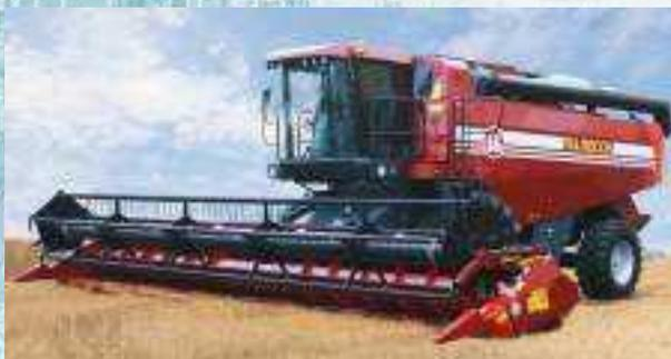
Зерноуборочный комбайн КЗС-1624-1 «ПАЛЕССЕ GS16» по производительности занимает верхнюю ступеньку модельного ряда комбайнов ПАЛЕССЕ. Машина современного технического уровня с двигателем мощностью 530 л.с. предназначена для сельхозпредприятий с крупными объемами уборки высокоурожайных зерновых колосовых, крупяных, зернобобовых и других обмолачиваемых культур.
