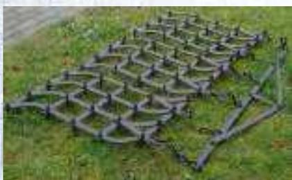
Предназначена для мелкого рыхления почвы перед посевом, заделки семян и минеральных удобрений, разрушения почвенной корки, закрытия влаги, уничтожение сорной растительности, а так же для довсходового боронования технических корнеплодных культур.
