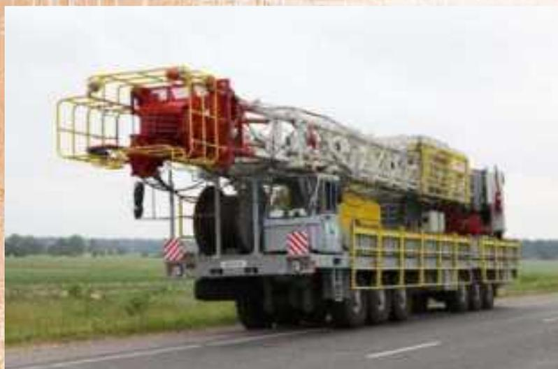
МЗКТ-800300-010 - шасси для монтажа и привода оборудования агрегата АРС-125 бурения и ремонта скважин и его транспортировки по дорогам всех категорий и без дорог.
