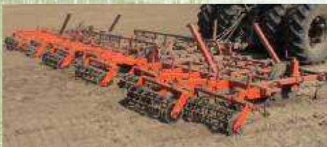
Предназначен для предпосевной обработки всех типов почв, за один проход по полю обеспечивает полную подготовку почвы к посеву, совмещая культивацию, рыхление, выравнивание и предпосевное прикатывание почвы с созданием в посевном слое уплотненного ложа для семян.
