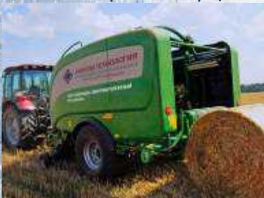
Предназначен для подбора сена естественных и сеянных трав, соломы, подвяленной травы с последующей обмоткой в сетку и пленку.
