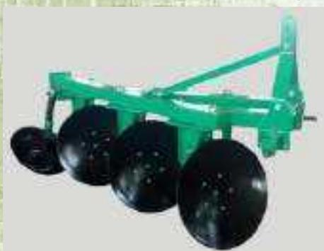
Плуг навесной дисковый ПНД-3 предназначен для обработки почвы на глубину 25...30 см. твёрдых высохших почв, а также почв с наличием древесных корней.
