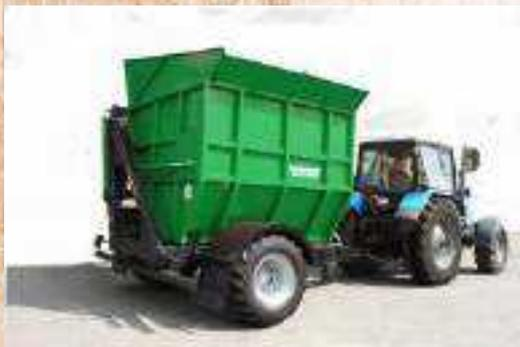
Полуприцеп выполнен со специальным телескопическим дышлом с целью увеличения возможностей использования, что позволяет при минимальной длине дышла, агрегатировать полуприцеп с трактором и, выполнять те же функции накопителя-перегрузчика.
