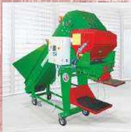
Взвешивающий бункер загружается корнеклубнеплодами с помощью ленточного транспортера с лопатками.
