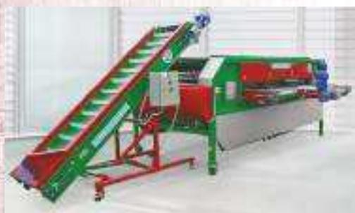
Машина калибровочная предназначена для автоматической сортировки-калибровки корнеклубнеплодов.
