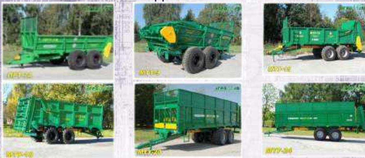
Предназначены для транспортировки и сплошного поверхностного внесения твердых органических удобрений.
