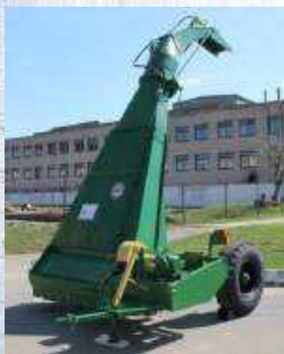
Косилка-измельчитель прицепная КИР-1,5-2 предназначена для уборки трав на силос или непосредственное скармливание животным. Косилка также может быть использована для уборки картофельной ботвы.
