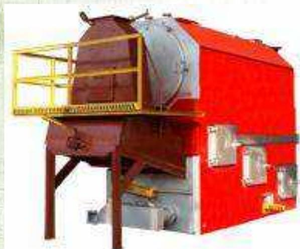
Котел водогрейный КВм-2,0Т предназначен для сжигания древесных отходов (щепы, опилок, стружки, дробленой коры), и фрезерного торфа с целью получения тепловой энергии для отопления и горячего водоснабжения жилых, производственных и административных зданий в закрытых системах теплоснабжения, в технологических процессах сушки древесины. Область применения: стационарные котельные.
