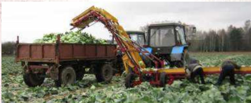
Предназначен для погрузки овощных культур при уборке в транспортные средства. Агрегируется с тракторами класса 1,4(типа МТЗ-80,82).
