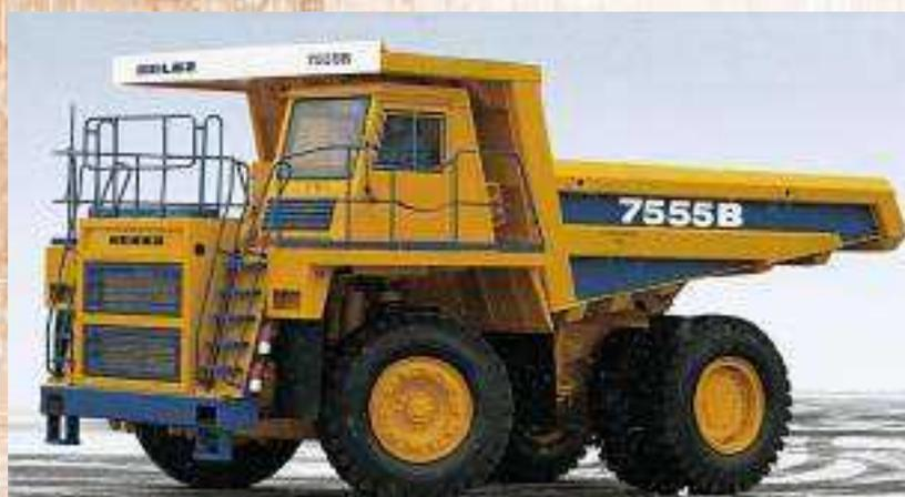
Карьерные самосвалы грузоподъемностью 55-60 тонн предназначены для перевозки горной массы в сложных горнотехнических условиях глубоких карьеров, на открытых разработках месторождений полезных ископаемых по технологическим дорогам в различных климатических условиях эксплуатации (при температуре окружающего воздуха от -50 до +50 градусов).
