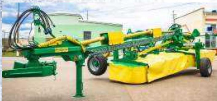
Косилка предназначена для кошения естественных и сеяных трав с укладкой скошенной массы на стерню в два валка.
