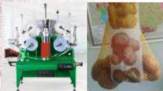
Серии автоматических упаковщиков МАУР предназначены для фасовки овощей и фруктов в плетеную сетку-рукав. Работает со всеми видами взвешивающих устройств, но рекомендовано использование с компьютерно-весовыми станциями КВС-12 и весоупаковщиками ВСП-50. В качестве дополнительного оборудования рекомендовано использовать крутящийся круглый стол и отводящие транспортеры. Это значительно упрощает работу.
