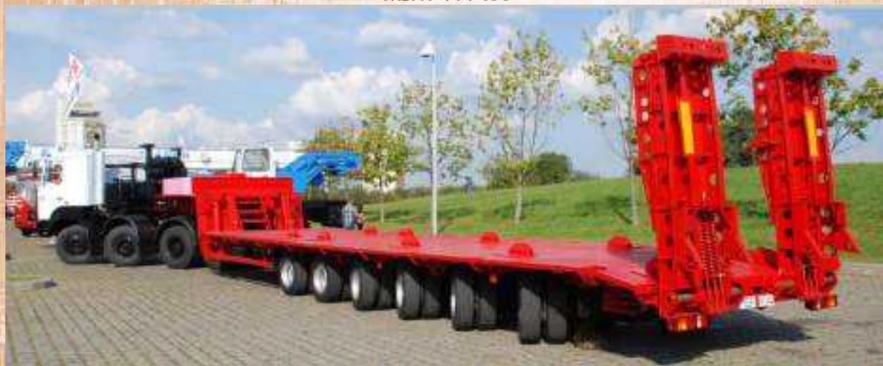
Предназначен для перевозки тяжелой техники и крупногабаритных неделимых грузов в составе автопоездов.
