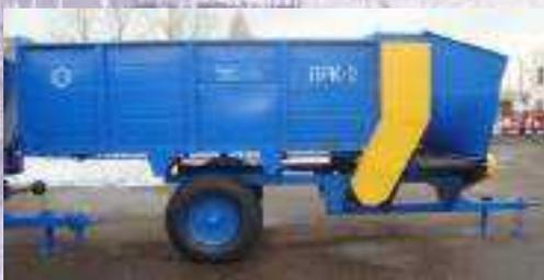
Раздатчик кормов ПРК-2 предназначен для перевозки и раздачи на ходу в кормушки на одну сторону измельченных листостебельных масс кукурузы, злаковых и бобовых трав, силоса, сена, сенажа или смеси их с другими сыпучими кормами, а также перевозки различных сыпучих сельскохозяйственных грузов.
