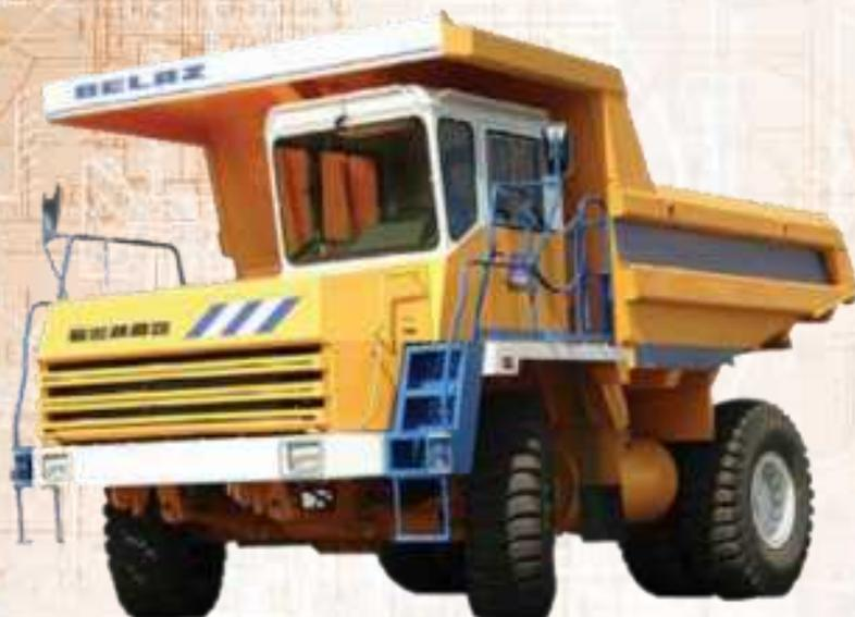
Карьерные самосвалы грузоподъемностью 30 тонн предназначены для перевозки горной массы в сложных горнотехнических условиях глубоких карьеров, на открытых разработках месторождений полезных ископаемых по технологическим дорогам в различных климатических условиях эксплуатации (при температуре окружающего воздуха от -50 до +50 градусов).
