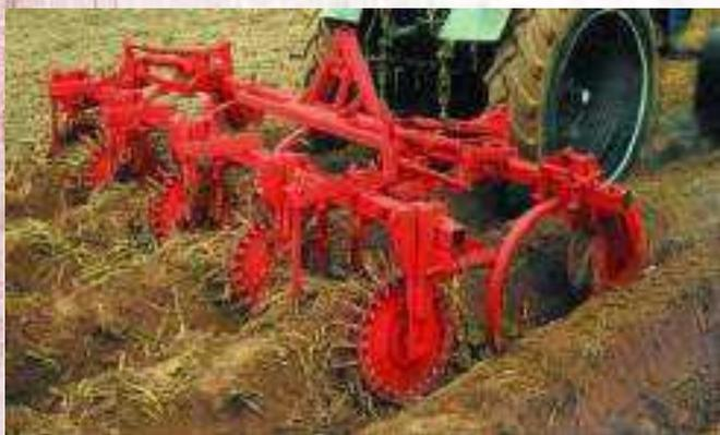
Культиватор-грядообразователь-орудие (КГО) предназначен для подготовки качественного семенного ложа одновременно с образованием гряд или гребней и прокладки технологической колеи с шириной междурядий 70 или 75 см; используются орудия с носовыми частями и вращающимися отвалами, приспособлениями для подготовки семенного ложа и гидрофицированного слепоуказателя.
