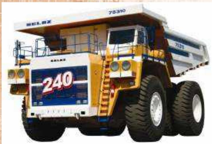
Карьерные самосвалы грузоподъемностью 240 тонн предназначены для перевозки горной массы в сложных горнотехнических условиях глубоких карьеров, на открытых разработках месторождений полезных ископаемых по технологическим дорогам в различных климатических условиях эксплуатации (при температуре окружающего воздуха от -50 до +50 градусов).
