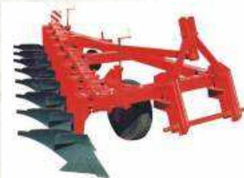
Плуг 8-ми корпусный навесной ПН-8-35У предназначен для пахоты под зерновые и технологические культуры на глубину до 27см, не засоренных камнями, плитняком и другими препятствиями, с удельным сопротивлением до 0,1 Мпа (1,0 кгс/см<sup>2</sup>). Плуг агрегируется с тракторами класса 5 кН (К-701, К-700А).
