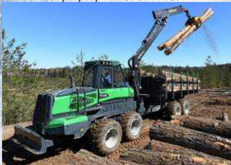
Форвардер АМКОDОР FF1681 — инновационная техника тяжелого класса повышенной производительности. Форвардер имеет широкий диапазон опций: удлинитель грузового отсека, уширители грузового отсека, систему продольного и вертикального перемещения щита, отвал, лебедку, систему блокировки тандемов балансирующего моста. Опционально оснащается лебедкой для самовытаскивания.
