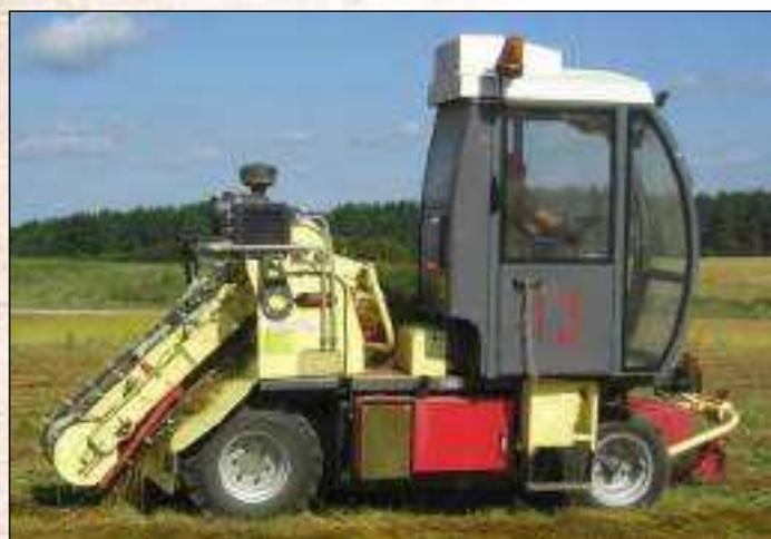
Оборачиватель лент льна самоходный ОЛЛ-1 предназначен для оборачивания лент льносолумы в процессе вылежки на льнице с целью сохранения ее качества и выравнивания цвета, а также для оборачивания лент тресты перед уборкой для ускорения ее естественной сушки и улучшения условий подбора.
