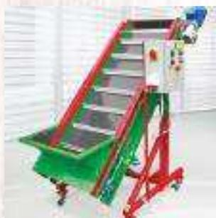
Конвейеры перегрузочные передвижные предназначены для приема корнеклубнеплодов и равномерной, непрерывной подачи их далее по технологическому циклу. Изготавливаются различных модификаций, в зависимости от высоты перегрузки.
