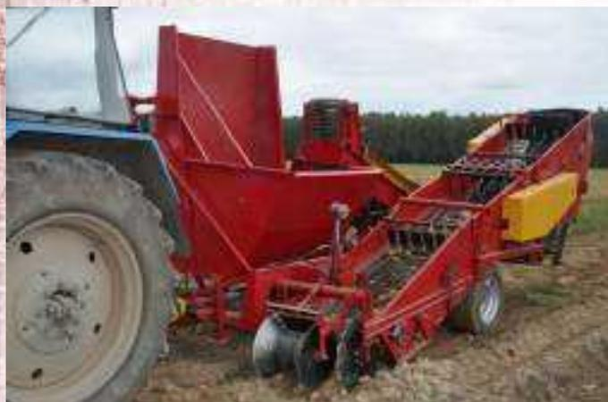
Комбайн картофелеуборочный ККУ-1 предназначен для механизированной уборки картофеля на легких и средних почвах, засоренных камнями до 28 т/га. Высокоэффективная система отделения ботвы, комков и камней благодаря усовершенствованным элеваторам и шиповым полотнам позволяет проводить уборку урожая в самых неблагоприятных условиях с минимальным повреждением клубней.
