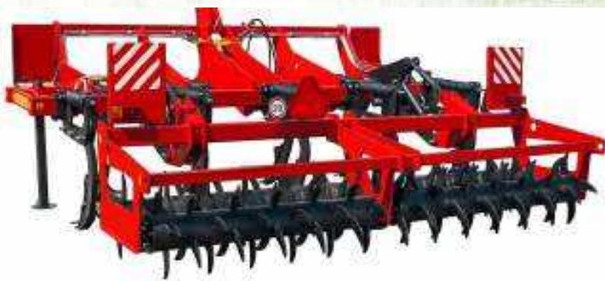
звеньев достигается эффект относительно равномерного силового распределения нагрузки на лапу при срабатывании системы от непроходимых препятствий. 3.кольчатые вальцы измельчают поверхностный слой почвы, что способствует удержанию влаги, а также уничтожению сорняка. гидравлическое управление положением кольчатых вальцов с возможностью установки заглубления лап глубокорыхлителя и использования вальцов как опоры.
