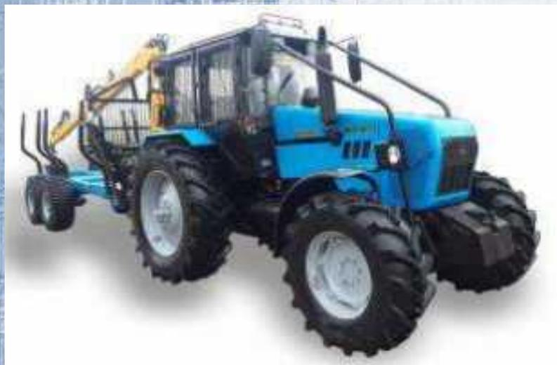
Предназначена для сбора и вывоза сортиментов к погрузочным площадкам или непосредственно к потребителю. Машина работоспособна в условиях равнинной и пересеченной местности. Машина может поставляться в следующих исполнениях:
