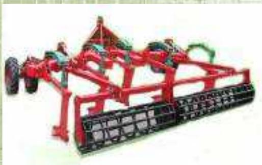
Плуг-глубокорыхлитель ГР-70 - это современный глубокорыхлитель с V-образной рамой для основной безотвальной обработки почвы и разрушения плужной подошвы в тяжелых условиях. Конструкция и расположение стоек обеспечивают тщательное глубокое рыхление без переноса подпахотного слоя на поверхность почвы. Рабочая глубина рыхления до 70 см.
