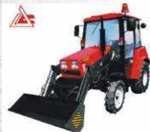
Машина состоит из базового трактора БЕЛАРУС 320.4 и закреплённого на нём погрузочного оборудования.
