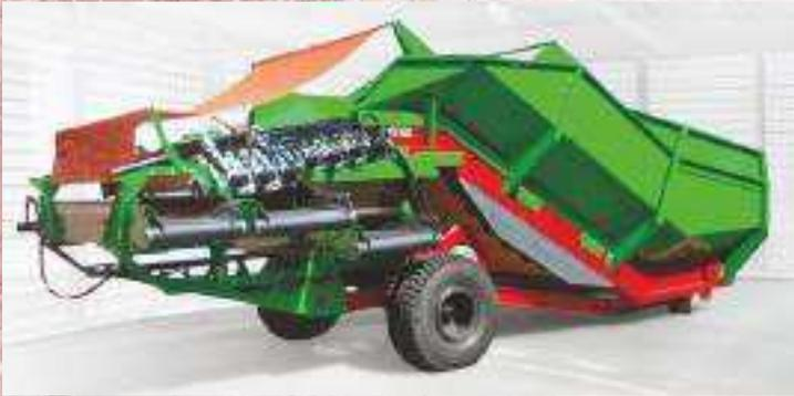
Пункт приемно-сортировочный предназначен для приема корнеклубнеплодов от самосвальных транспортных средств с задней выгрузкой, частичного отделения почвенных примесей, отделения мелкой и (или) семенной фракции и загрузки клубней в контейнер или подачи на загрузочный конвейер. Пункт может применяться во всех зонах возделывания картофеля, корнеплодов и лука.
