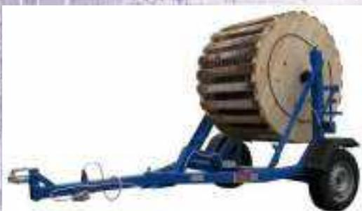
Одноосные транспортеры кабельные КТ-1 без тормозов предназначены для прокладки (подвески) и обслуживания телефонных и силовых кабелей.
