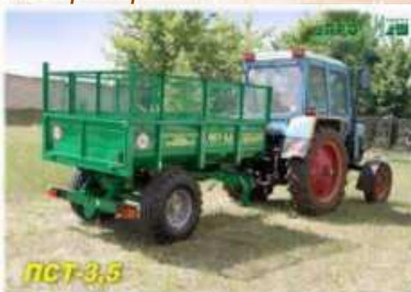
Полуприцеп состоит из рамы, ходовой системы, кузова с открывающимися боковыми и задним бортами, гидропривода для опрокидывания кузова назад, тормозной системы, состоящей только из стояночного тормоза, электрооборудования. Ходовая система безрессорная, в виде одной оси с двумя колесами. Полуприцеп комплектуется надставными передним и боковыми бортами.
