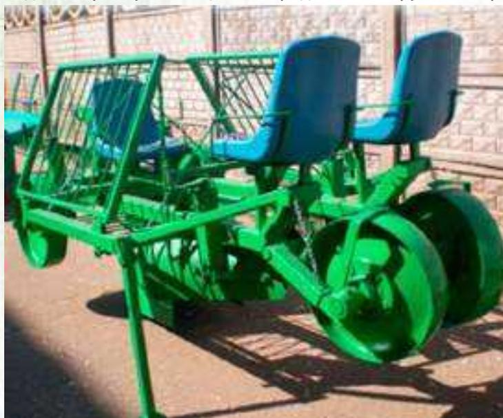
В процессе движения агрегата после установки саженца в борозду с помощью двух отвалов (загортывателей) происходит засыпка борозды.
