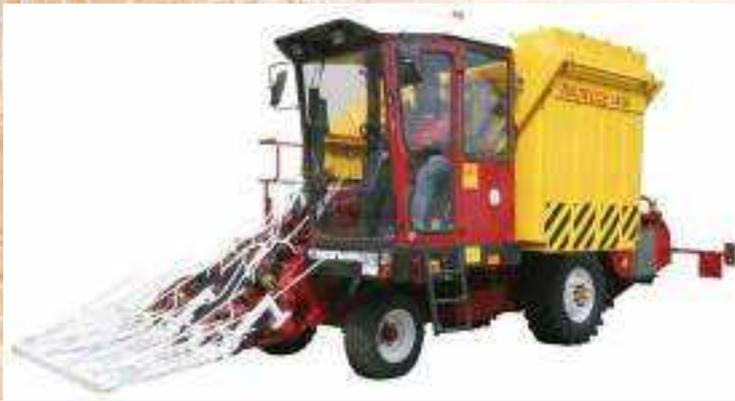
Комбайн льноуборочный самоходный КЛС-3,5 предназначен для тербления стеблей льна-долгунца в период ранней желтой и желтой спелости с одновременным очесом семенных коробочек, сбором очесанного вороха в бункер и расстилом стеблей в ленту на льнице. Комбайн может быть использован для тербления льна с расстилом стеблей в ленту без очеса семенных коробочек.
