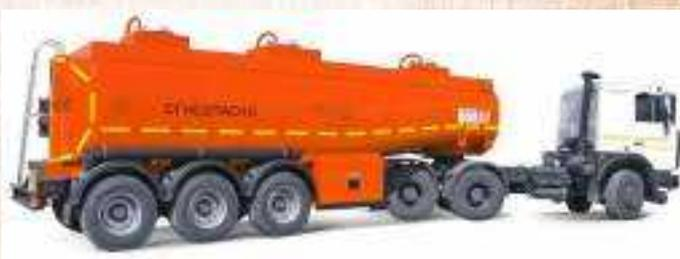
Предназначена для транспортировки и кратковременного хранения светлых нефтепродуктов плотностью не более 0,83 т/м<sup>3</sup> и является мерой полной вместимости.
