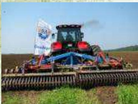
**СЦЕПКИ АГРЕГАТОВ ДИСКОВЫХ НАВЕСНЫХ** состоят из навесной сцепки С и двух стандартных агрегатов АДН «ДИСКАТОР» с шириной захвата 2,5 - (5,0м.); 3,0 - (6,0м.); 3,5 - (7,0м.) и 4,0м. - (8,0м.).
