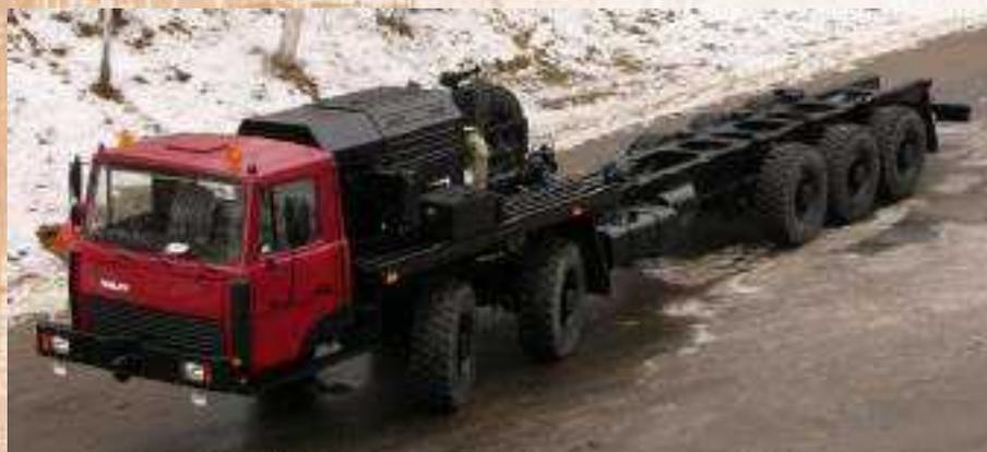
Шасси под монтаж различного специального оборудования и его транспортировки по дорогам всех категорий и без дорог.
