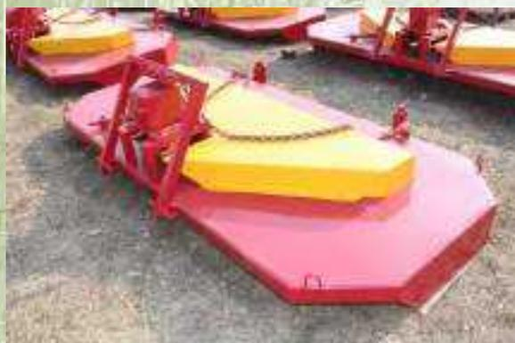
Косилка-измельчитель предназначена для скашивания трав, срезания и измельчения грубостебельной, мелкокустарниковой растительности, как на ровных площадях, так и на неудобьях. Косилка применяется в садоводстве, растениеводстве, при уходе за полосами отвода автомобильных и железных дорог, лесопарковыми зонами
