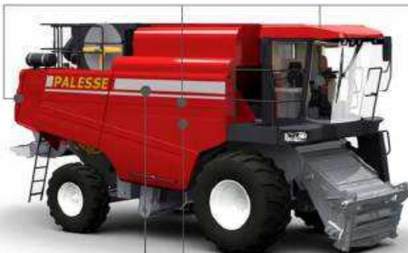
Применены боковые гибридно-пластиковые капоты и декоративные пластиковые ограждения на капоте солоотряса. Изменены транспортные фары, бампер и маски на подрамнике кабины. Изменен материал отделки внутри кабины.
