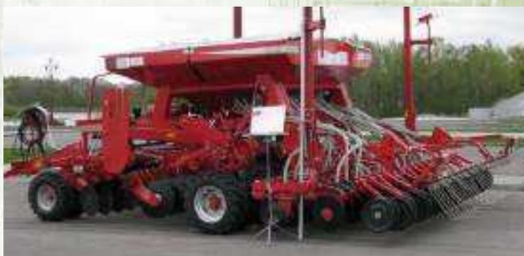
Выполнен в прицепном варианте. Прицепной вариант позволяет снизить нагрузку на трактор, обеспечить в отличие от полунавесного более точную обработку агрегатом по глубине за счет наличия передних и задних опорных колес.
