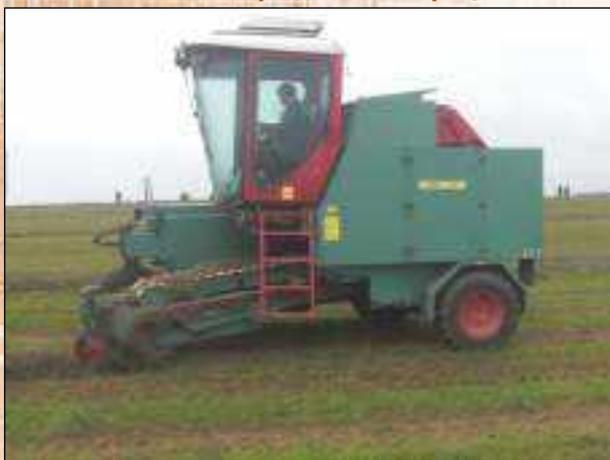
Пресс-подборщик лент льна самоходный ПЛС-1,5 предназначен для подъема льнотресты с прессованием в рулоны цилиндрической формы, с прокладкой шпагата по всей длине ленты льна и последующей внешней обвязкой.
