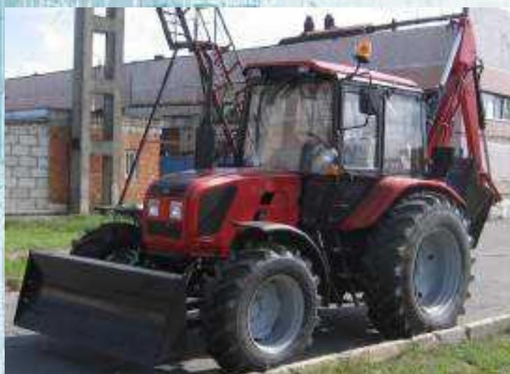
Экскаватор-бульдозер ЭО-2621 укомплектован навесным экскаваторным оборудованием и бульдозерным отвалом, используется для выполнения земляных, экскаваторных и погрузочно-разгрузочных работ на грунтах 1 и 2 категорий. По техническим характеристикам, технологичности превосходит аналогичные модели производства стран СНГ. Высокая производительность сочетается с легкостью управления, надежностью в эксплуатации и простотой обслуживания.
