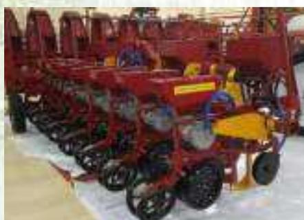
**СТВ6Д, 8Д**, - предназначена для точного высева калиброванных семян кукурузы, подсолнечника, клещевицы, сорго, сои, а так же семян кормовых бобов, фасоли, люпина с заделкой их в почву двухдисковым сошником, прикатыванием почвы в рядках. Сеялки гарантируют качественный посев по традиционной и ресурсосберегающим технологиям земледелия.
