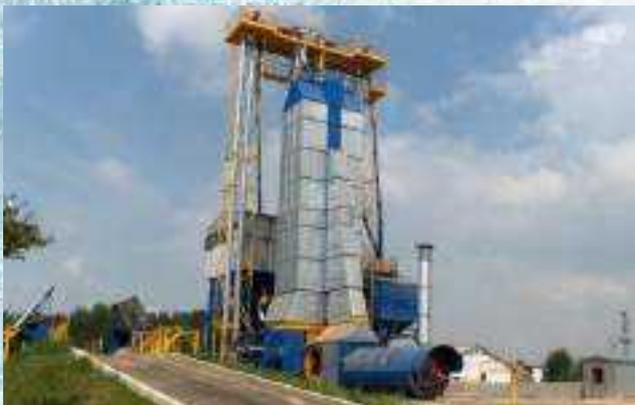
Зерносушильно-очистительный комплекс стационарный открытого типа предназначен для послеуборочной очистки и сушки зерна и семян зерновых колосовых, зернобобовых, рапса, кукурузы и крупяных культур продовольственного и фуражного назначения с исходной влажностью до 30%.
