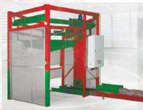
Предназначен для автоматической упаковки в полиэтиленовые мешки на паллеты с целью их удобного транспортирования и хранения.
