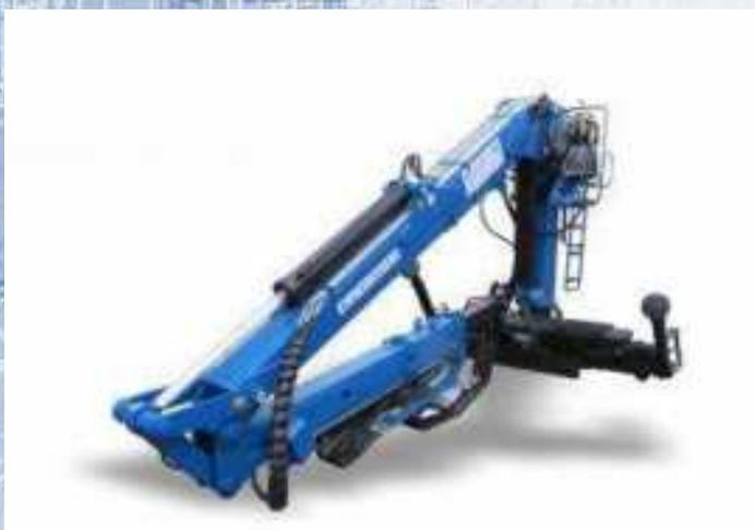
Манипулятор М75-04 предназначен для установки на сортиментовозы и выполнения погрузочно-разгрузочных работ в их составе.
