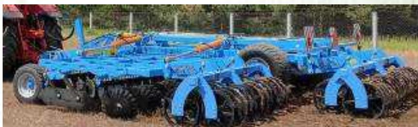
предпосевной обработки почвы, в том числе по стерне или непаханому полю. Стойки с дисками Bellota из закаленной боронасыщенной стали соединены с рамой с использованием резиновых амортизаторов. Последние выполняют функции подвески и демпфера и тем самым защищают подшипники от возможных временных динамических нагрузок.
