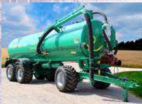
Машина для внесения жидких органических удобрений МЖУ-20А предназначена для самозагрузки, транспортирования и внесения жидких органических удобрений. Отличительным признаком новой машины является трёхосная ходовая система вместо двухосной с целью снижения давления на почву и снижения нагрузки на ТСУ трактора.
