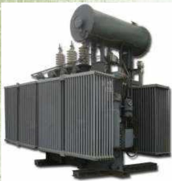
Трансформатор силовой масляный трехфазный двухобмоточный ТМН-6300/110 с естественной циркуляцией воздуха и масла, с регулированием напряжения под нагрузкой (РПН) предназначен для преобразования и поддержания заданного уровня напряжения в распределительных сетях общего назначения 110 кВ. Климатическое исполнение и категория размещения по ГОСТ 15150-90 - У1. Допустимая высота установки над уровнем моря. М - до 1000.
