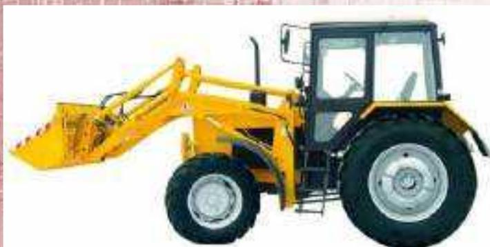
Погрузчики АМКОДОР 134 и АМКОДОР 134-01 предназначены для выполнения земляных работ на грунтах I-II категории и погрузочно-разгрузочных работ, планировки строительных площадок и грунтовых дорог, засыпки траншей и ям, подъема и перемещения штучных грузов и других хозяйственных нужд.
