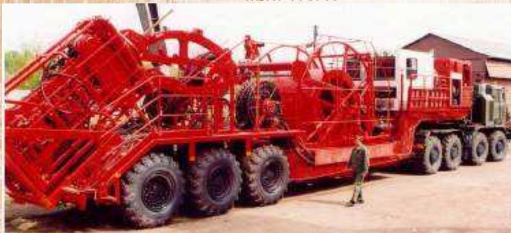
Предназначен для перевозки тяжелой техники и крупногабаритных неделимых грузов в составе автопоездов.
