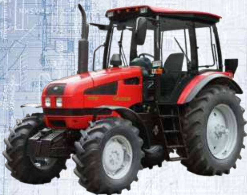
Трактор предназначен для выполнения различных сельскохозяйственных работ с навесными, полунавесными и прицепными машинами и орудиями, работ на транспорте.
