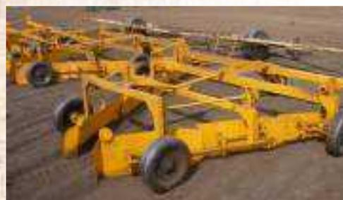
Валкователь фрезерного торфа АМКOДОР АТВЛ-18 предназначен для собирания высушенного торфа из расстила и формирования его в валки правильной треугольной формы в поперечном сечении на картах 20 м и 40 м с целью подготовки высушенного фрезерного торфа к последующей его уборке машиной для уборки фрезерного торфа АТУ-20 на полях сушки производственных площадей торфопредприятий при фрезерном способе добычи торфа. Валкователь фрезерного торфа должен эксплуатироваться на торфяных
