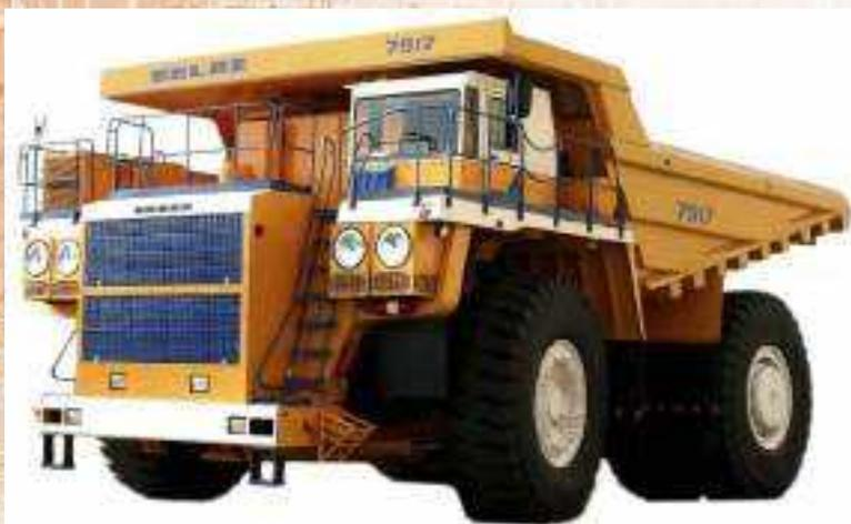
Карьерные самосвалы грузоподъемностью 160 тонн предназначены для транспортирования горной массы в разрыхлённом состоянии по технологическим дорогам на открытых разработках полезных ископаемых с различными климатическими условиями. Могут использоваться на строительстве крупных и гидротехнических сооружений, при дорожномагистральных комплексах, а также в технологических подразделениях предприятий
