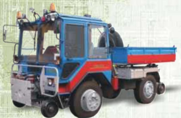
Шасси универсальное «БЕЛАРУС» Ш-446-01 предназначено для круглогодичного содержания и уборки автомобильных дорог и железных дорог колеи 1520 мм, благоустройства производственных территорий.
