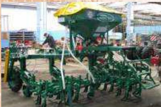
Предназначен, для междурядной обработки хлопчатника и других высокостебельных культур период вегетации, посеянных 4х рядными сеялками.
