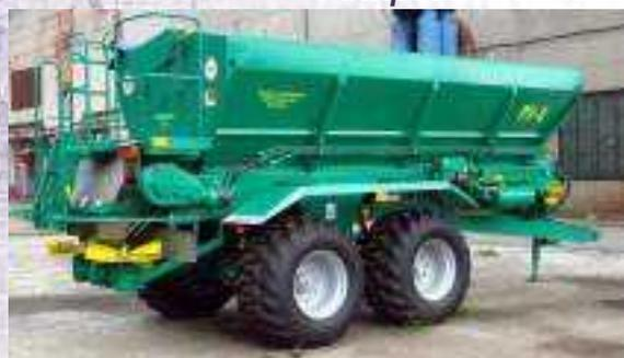
Распределитель минеральных удобрений РУ-8 предназначен для поверхностного внесения твердых минеральных удобрений в гранулированном или кристаллическом виде и известковых химмелиорантов.
