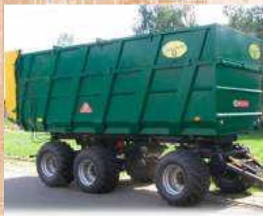
Прицеп ЗПТС-19 предназначен для перевозки и выгрузки силосной массы, также различной сыпучей продукции сельскохозяйственного производства.
