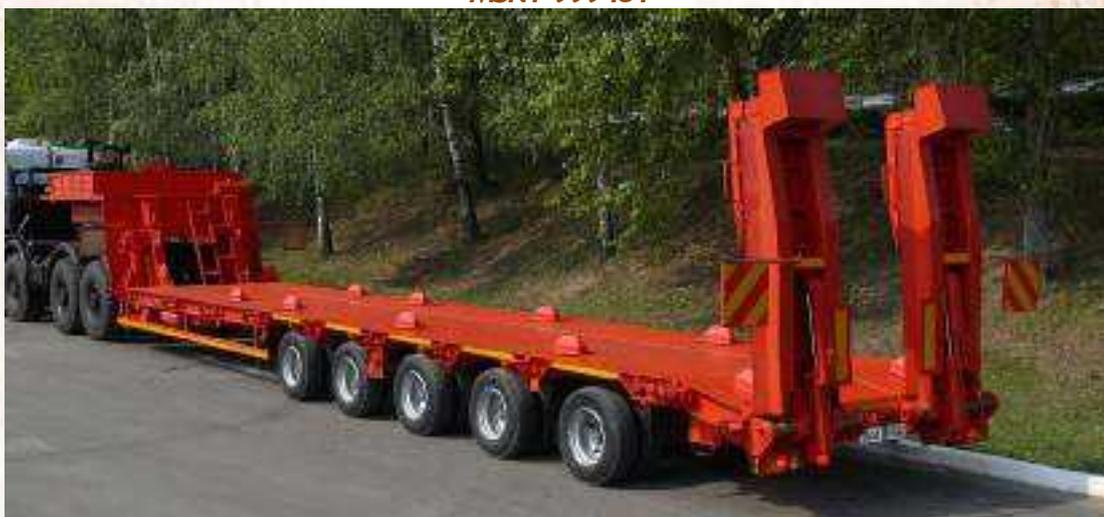
Предназначен для перевозки тяжелой техники и крупногабаритных неделимых грузов в составе автопоездов.
