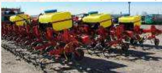
Культиватор-опрыскиватель КОУП-8 предназначен для междурядной обработки почвы с одновременным внесением пестицидов и удобрений при возделывании овощных и других сельскохозяйственных культур.
