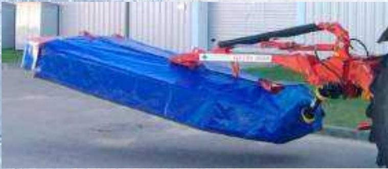
Стандартно косилка оснащена системой регулировки давления на почву в зависимости от типа почвы и рельефа местности. Разгрузочные пружины имеют 3 степени регулировки силы нажима режущего аппарата на почву.
