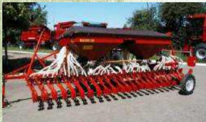
Сеялка пневматическая универсальная СПУ-6Д предназначена для посева практически всех зерновых, зернобобовых и травяных культур, таких как: пшеница, рожь, ячмень, овес, горох, люпин, клевер, вика, репа, морковь, брюква и т.д. на почвах, подготовленных под посев с применением минеральных и органических удобрений. При этом обеспечивается высокая точность посева.
