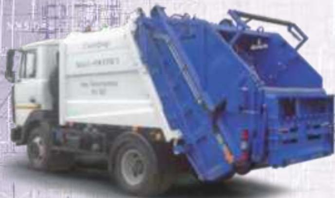
Предназначены для механизированной и ручной загрузки, уплотнения, транспортировки и выгрузки твердых коммунальных отходов
