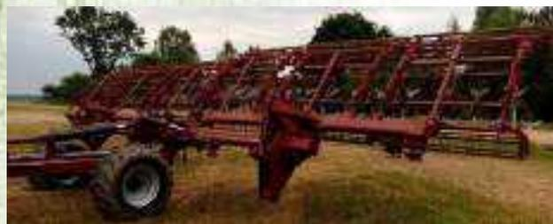
Агрегат модульный прицепной АМП-12-S предназначен для работы на легких и средних почвах (по механическому составу) после предшествующей основной обработки, в том числе по зяблевой вспашке, после предварительной культивации, а также после уборки однолетних трав, рапса и других крестоцветных культур, картофеля и других корнеклубнеплодов. Допускается их
