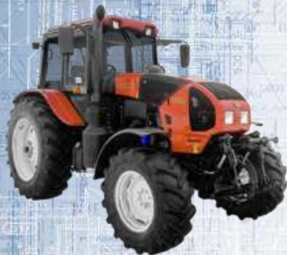
Трактор предназначен для выполнения различных сельскохозяйственных работ с навесными, полунавесными и прицепными машинами и орудиями, транспортных работ. Экологический стандарт Stage IV.
