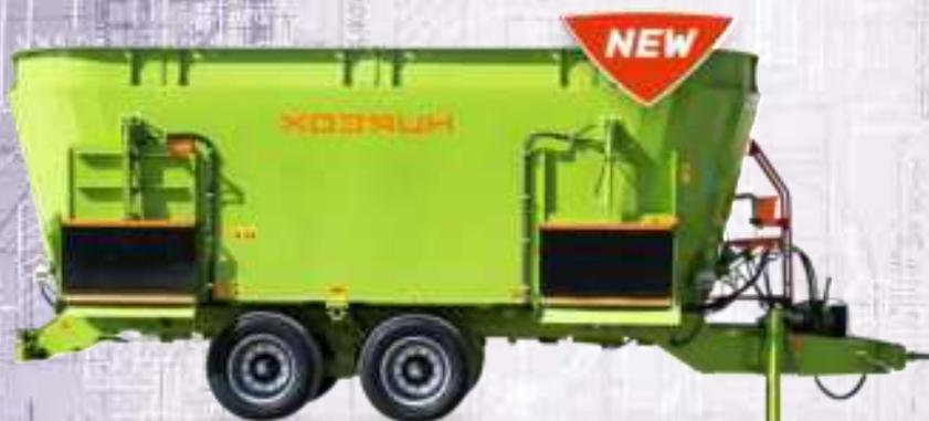
Предназначен для доизмельчения, смешивания и раздачи полнорационной кормовой смеси крупному рогатому скоту в кормушки и на кормовой стол.
