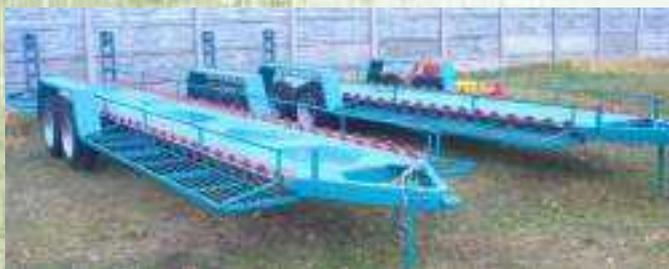
Предназначена для транспортировки плодовоовощной продукции в контейнерах размером 1200х950х750. Тележка ТКС-3 агрегируется с тракторами МТЗ 80/82, МТЗ 890/892.
