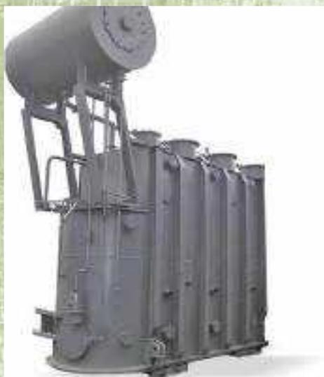
Трансформатор силовой масляный трехфазный двухобмоточный ТРДН-25000/110 с регулированием напряжения под нагрузкой и системой охлаждения Д предназначен для работы в электрических сетях общего назначения 110 кВ.
