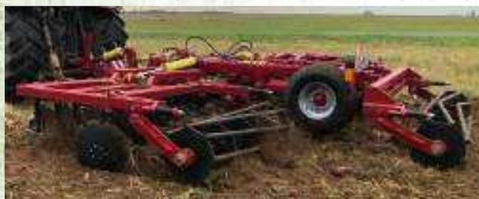
БДМТ-6 предназначена для традиционной, минимальной основной и предпосевной обработки почвы на глубину до 15 см, уничтожения сорняков, измельчения пожнивных остатков, омоложения лугов и пастбищ под зерновые, технические и кормовые культуры.
