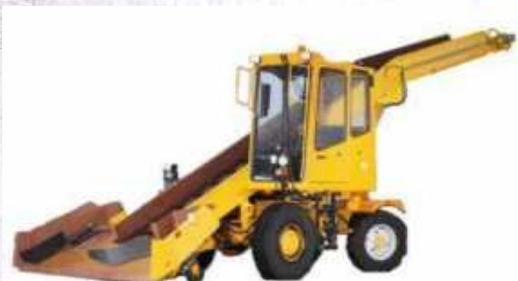
Машина погрузочная универсальная Амкодор 37/37-01 предназначена для погрузки в транспортные средства свежевыпавшего, уплотненного снега и сколотого льда, предварительно собранных в валы и кучи, а также для других работ с помощью сменных рабочих органов.
