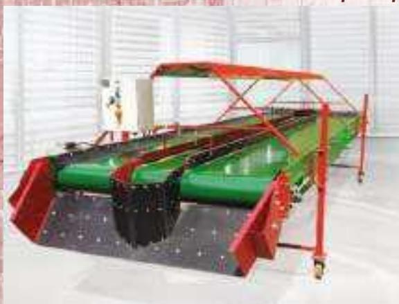
Стол переборочный ленточный предназначен для ручной инспекции корнеклубнеплодов. Некачественные, битые, подгнившие, нестандартные, корнеклубнеплоды помещаются в разделитель, находящийся в центральной части стола, откуда автоматически попадают на отводящий транспортёр или в специальную тару.
