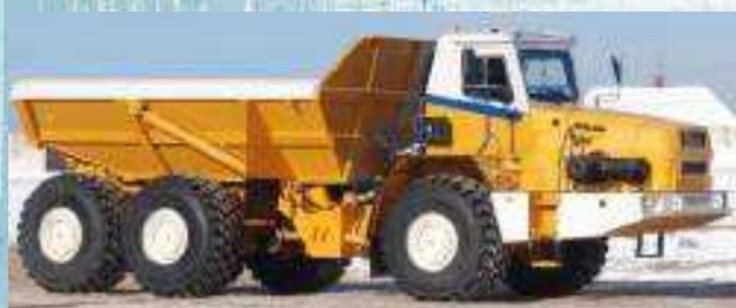
Предназначены для перевозки насыпных грузов и рассчитаны на эксплуатацию в различных климатических условиях как по специальным технологическим дорогам, так и в условиях бездорожья на грунтах с низкой несущей способностью.
