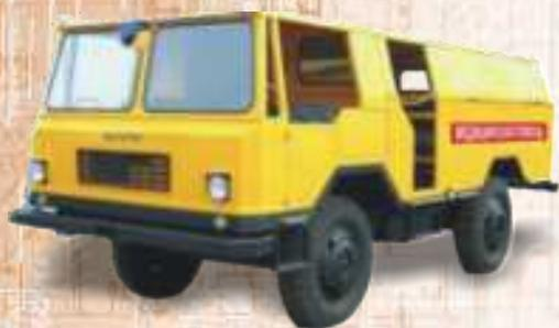
Машина медицинской помощи шахтная «БЕЛАРУС» ММП-393М предназначена для доставки специально подготовленного персонала и необходимого оборудования на место происшествия, оказания медицинской помощи и транспортировки больных или пострадавших к стволу в подземных рудниках по горизонтальным и наклонным горным выработкам арочного типа.
