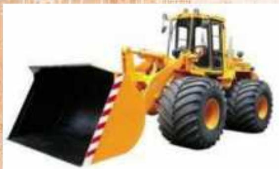
Специально разработаны для торфопредприятий и оснащены широкопрофильными шинами сверхнизкого давления, которые позволяют работать на грунтах с очень низкой несущей способностью.
