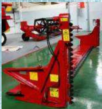
Приспособление для уборки рапса ПР предназначены для установки на зерновые жатки шириной захвата 5, 6, 7 и 9 м к зерноуборочным комбайнам ПАЛЕССЕ. Использование рапсовых столов ПР позволяет снизить потерю семян при уборке урожая на треть.
