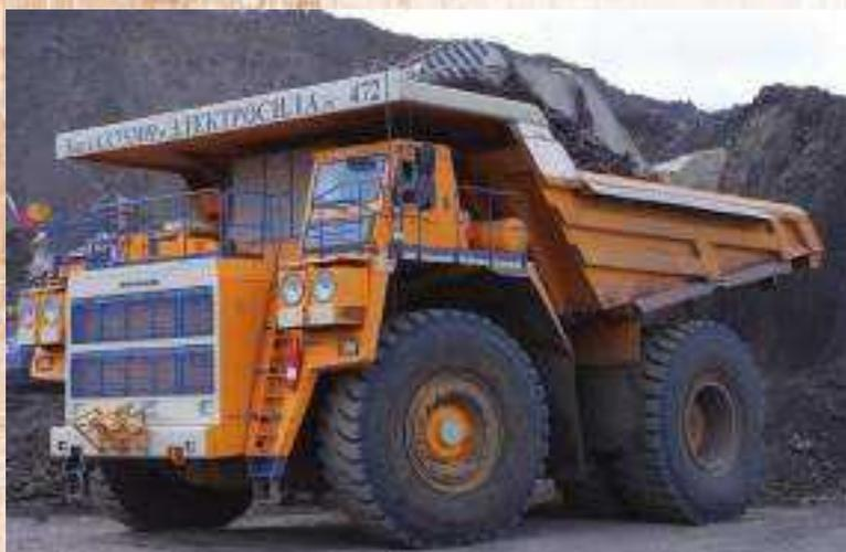
Карьерные самосвалы грузоподъемностью 200-220 тонн предназначены для перевозки горной массы в сложных горнотехнических условиях глубоких карьеров, на открытых разработках месторождений полезных ископаемых по технологическим дорогам в различных климатических условиях эксплуатации (при температуре окружающего воздуха от -50 до +50 градусов).
