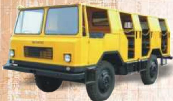
Машина транспортная шахтная «БЕЛАРУС» МТ-353М2 предназначена для перевозки людей по горизонтальным и наклонным горным выработкам арочного типа.
