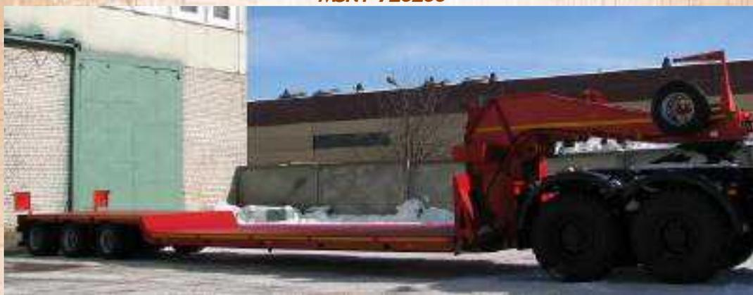
Предназначен для перевозки тяжелой техники и крупногабаритных неделимых грузов в составе автопоездов.
