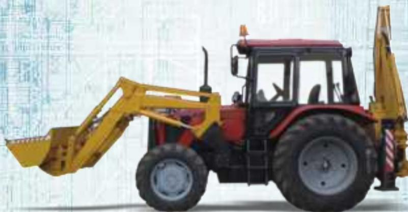
Экскаватор-погрузчик предназначен для выполнения земляных работ на грунтах от I до IV категории, погрузочно-разгрузочных работ небольшого объема, транспортировки сыпучих материалов на небольшие расстояния, планировки площадок, засыпки траншей насыпным грунтом, уборочных работ.
