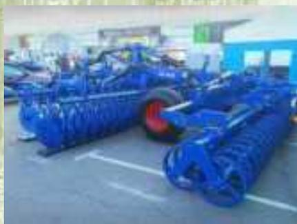
Агрегат дисковый почвообрабатывающий АД-600 М «Рубин» обеспечивает в тяжелых почвенных условиях интенсивное и равномерное перемешивание органической массы и почвы, при этом значительно снижая потерю влаги от испарения. Таким образом, Рубин наилучшим образом подходит для поверхностной, стерневой обработки почвы при высокой рабочей скорости. Агрегат предназначен для эксплуатации на легких, средних и тяжелых почвах.
