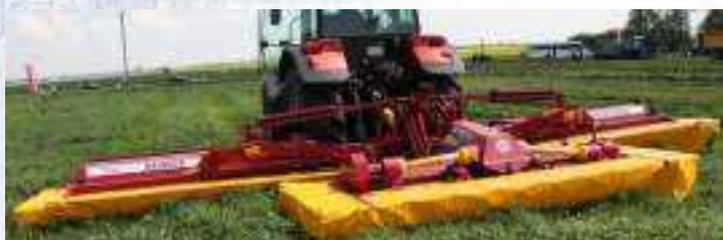
Косилка-плющилка КПр-9 «ПАЛЕССЕ СН90» предназначена для кошения зеленых сеяных и естественных трав с одновременным плющением и укладкой скошенной массы на стерню в три валка. Косилка может быть использована для кошения трав без плющения с укладкой скошенной массы в валки.
