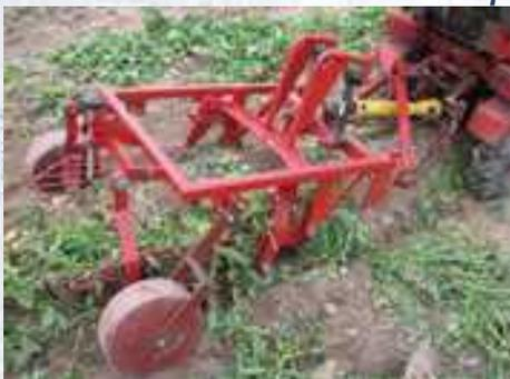
Картофелекопалка КФТ2-01 предназначена для механизированного выкапывания картофеля, отделения клубней от земли и укладки на поверхность для дальнейшего ручного сбора на небольших земельных участках.
