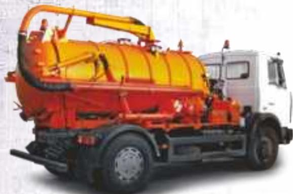
Илососная машина предназначена для механизированной очистки дождеприемников городской дождевой канализационной сети от ила и транспортировки его к месту выгрузки
