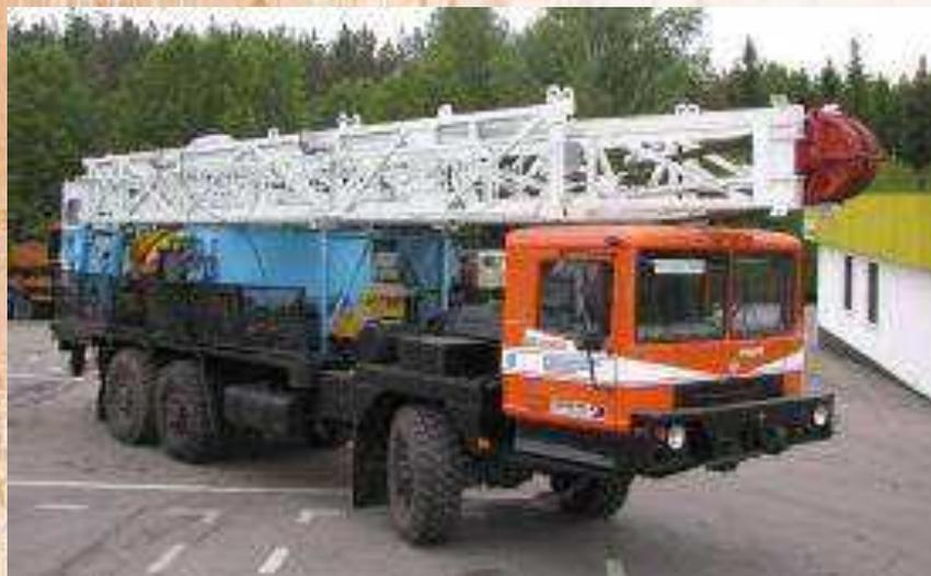
Шасси специальное МЗКТ-800770 предназначено для монтажа различного специального оборудования и его транспортировку по всем видам дорог и без дорог.
