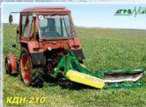
Косилка предназначена для скашивания естественных и сеянных трав, в том числе высокоурожайных и полеглых с укладкой скошенной массы в прокос. Косилка применяется во всех зонах, кроме горных, на выровненных лугах (сенокосах) не засоренных камнями, выступающими из почвы не более чем на 30 мм.
