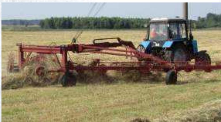
Предназначены для сгребания провяленной травы из прокосов в валки и оборачивания валков. Грабли используются для уборки сеяных трав, а так же трав естественных сенокосов урожайностью свыше 10 ц/га на равнинах при влажности массы от 25 до 80% на выровненных полях и склонах крутизной до 8°, не имеющих глубоких борозд, рвов. Поле должно быть выровнено.
