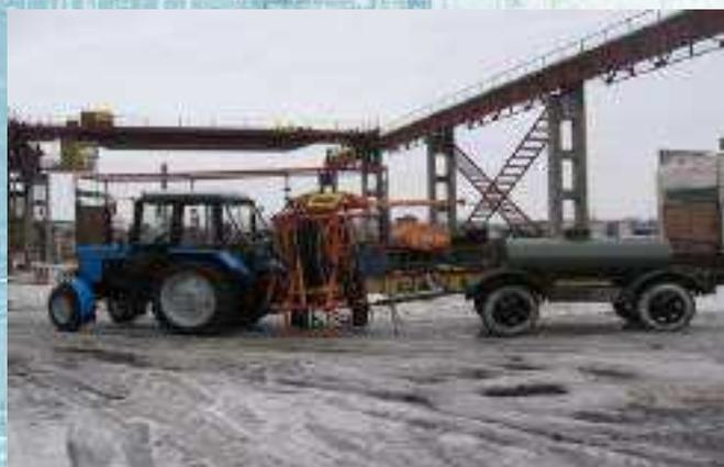
Установка для промывки дренажа, предназначена к применению в агропромышленном комплексе для промывки сильно загрязненных дренажных систем на мелиорированных землях и не имеет аналогов на постсоветском пространстве.
