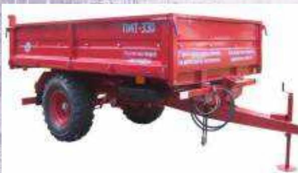
Полуприцеп агрегируется с тракторами БЕЛАРУС-320 и БЕЛАРУС-422, имеющими тягово-сцепное устройство ТСУ-1М. Полуприцеп производства ОАО «БЗТДиА» ПМТ-330 предназначен для транспортировки различных сыпучих грузов с выгрузкой назад в коммунальных хозяйствах и дорожно-строительных предприятиях. В отличие от аналогов полуприцеп имеет увеличенные размеры кузова, регулируемое по высоте и поддресоренное дышло, полуприцеп оснащен колодочными тормозами с пневмоприводом,
