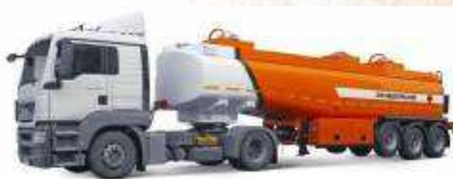
Корпус цистерны выполнен в виде горизонтального резервуара с внутренними ребрами жесткости (волнорезами) плосковыгнутой формы, которые усиливают надежность всей конструкции цистерны и препятствуют возникновению гидроударов.
