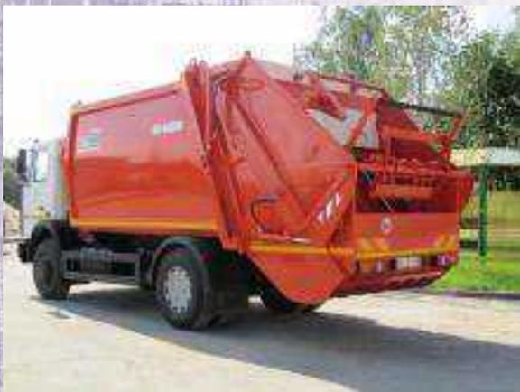
Мусоровоз с задней загрузкой КО-440ВМ предназначен для механизированного сбора твердых бытовых отходов из металлических и пластмассовых контейнеров всех типов, до 1,1 м<sup>3</sup>, их уплотнения, транспортирования, и механизированной выгрузки в местах утилизации.
