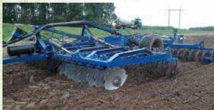
Агрегат почвообрабатывающий АДС-6 предназначен для обработки залежных земель, стерни зерновых культур, полей после уборки кукурузы, технических культур и полей с сидератами, разделки пластов почвы после вспашки, а также предпосевной обработки почвы. Зубчатые полусферические диски с диаметром 736 мм и толщиной 6 мм позволяют осуществлять обработку почвы до 22 см. Диски установлены под углом 20° к поверхности почвы и
