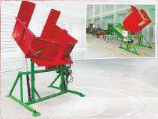
Опрокидыватель контейнеров предназначен для выгрузки содержимого контейнеров с продукцией в приемные бункера.
