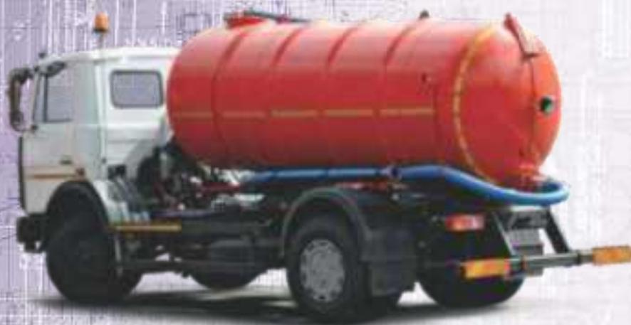
Предназначены для илососной очистки выгребных ям и канализационных колодцев, транспортирования и выгрузки в местах утилизации жидких отходов, не содержащих горючих и взрывоопасных веществ
