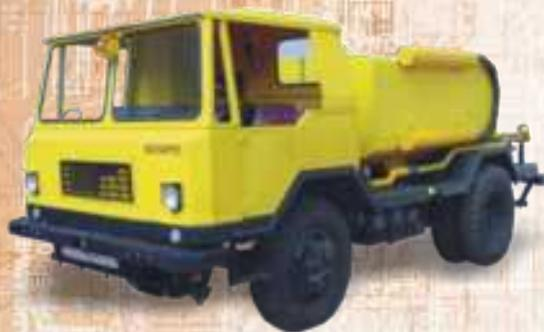
Машина поливочная шахтная «БЕЛАРУС» МПЛ-373М предназначена для поливки горных выработок и тушения пожаров в подземных рудниках арочного типа.
