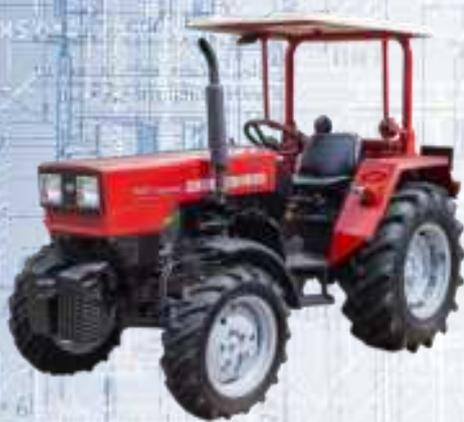
Тракторы предназначены для выполнения различных работ в сельском хозяйстве в агрегате с навесными, полунавесными и прицепными машинами, в промышленности и на транспорте. Малые габариты, высокий дорожный просвет, конечная передача с планетарным редуктором. Трактор BELARUS 451 выполнен на базе трактора BELARUS 651. Экологический стандарт Stage IIIa.
