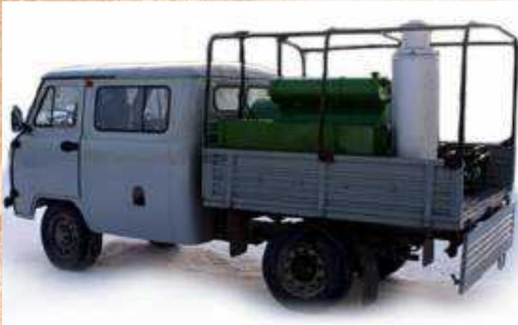
**Автомобиль специальный с установкой подвижной дезинфекционной УД-1 на платформе автомобиля УАЗ-330365**
