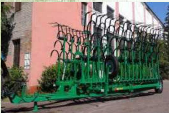
Культиватор паровой скоростной КПС-13 предназначен для сплошной обработки паров, закрытия влаги, предпосевного рыхления почвы с подрезанием и вычесыванием корнеотпрысковых сорняков.
