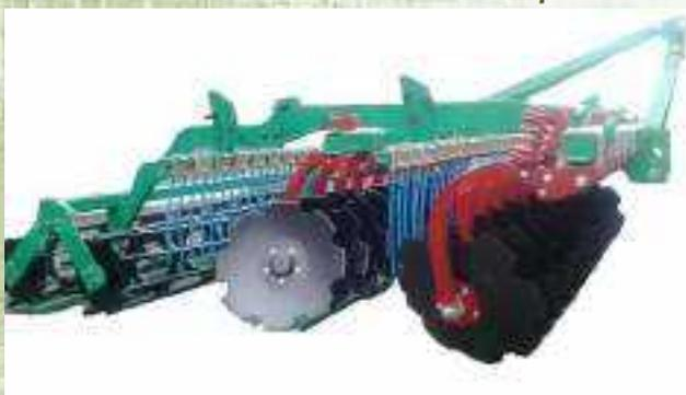
Двухрядная ротационная дисковая борона с полусферическими зубчатыми дисками и прикатывающими катками. Грядили полусферических дисков, размещенные в закрытых кронштейнах, защищены посредством спиралевидных пружин от перегрузок и гарантируют стабильную работу дисков в борозде даже в тяжелых условиях.
