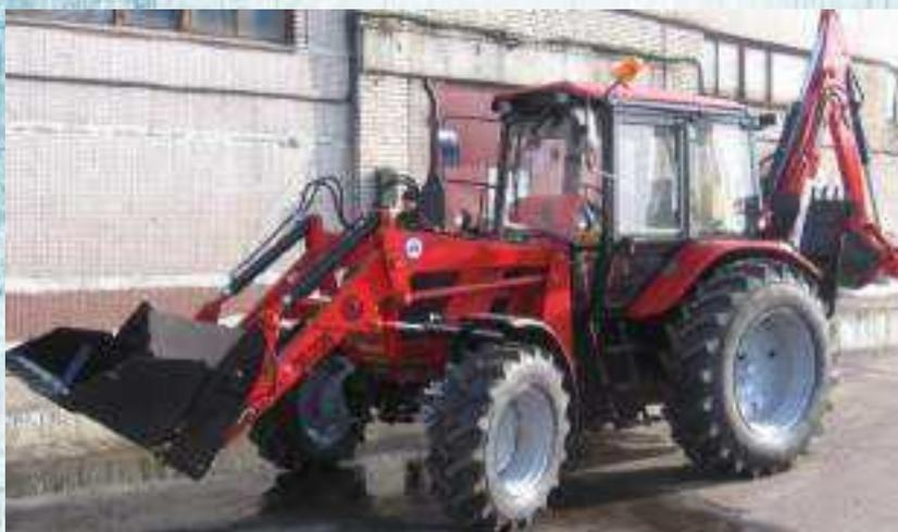
Экскаватор-погрузчик ЭО-2626 с челюстным погрузочным ковшом используется для выполнения земляных, экскаваторных и погрузочно-разгрузочных работ на грунтах 1 и 2 категорий. По техническим характеристикам, технологичности превосходит аналогичные модели производства стран СНГ. Высокая производительность сочетается с легкостью управления, надежностью в эксплуатации и простотой обслуживания.
