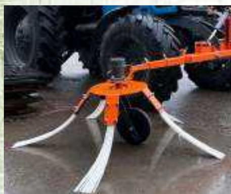
При использовании в тандеме с косилкой-измельчителем на задней навеске, можно одновременно выгребать ветки и сразу мульчировать их.
