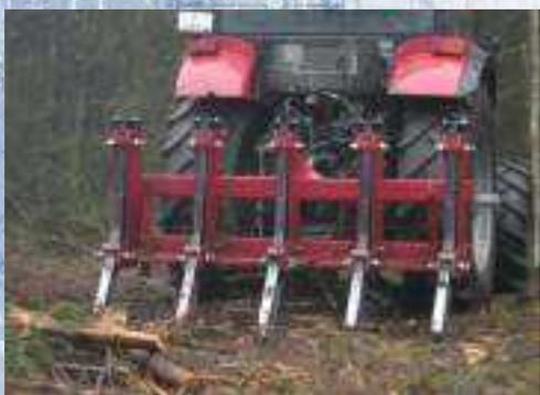
Сгребатель веток леса СВЛ-2,1 - предназначен для сгребания ветвей деревьев после сплошной вырубki и формирования из них валов древесно-кустарниковой массы. Собранные древесные отходы могут вывозиться или измельчаться на месте, а очищенная территория - подвергаться дальнейшей обработке для ускорения лесовосстановления.
