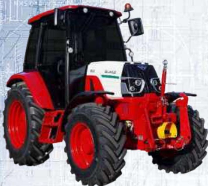
Трактор предназначен для выполнения различных сельскохозяйственных работ с навесными, полунавесными и прицепными машинами и орудиями, для выполнения погрузочно-разгрузочных работ, работ на транспорте, привода стационарных сельскохозяйственных машин.
