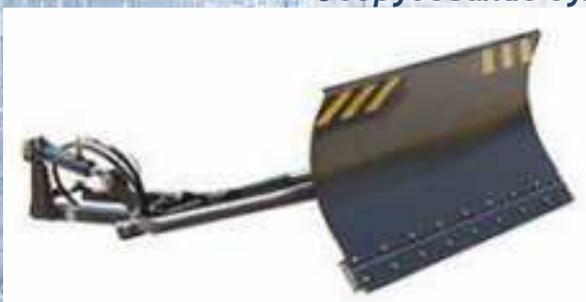
Оборудование бульдозерное ОБ12-00.000 предназначено для очистки проезжей территорий от свежесвыпавшего снега и от мусора, а также для планировки несляжавшегося (рыхлого) насыпного грунта и засыпки им траншей и ям.
