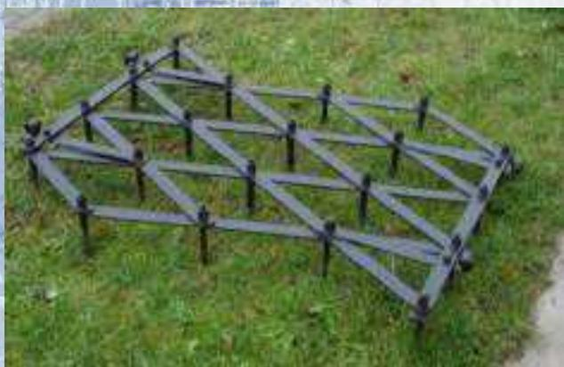
Предназначена для рыхления почвы и выравнивания поверхности поля, закрытия влаги, уничтожения всходов сорняков, разбивания комков почвы, а также для боронования всходов зерновых и технических культур.
