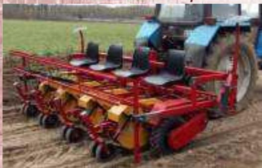
Машина рассадопосадочная МРП навесная двух или четырехрядная предназначена для посадки кассетной рассады овощных культур (капусты, перца и т.д) в открытый грунт. Агрегатируется с тракторами тягового класса 0,6-2,0.
